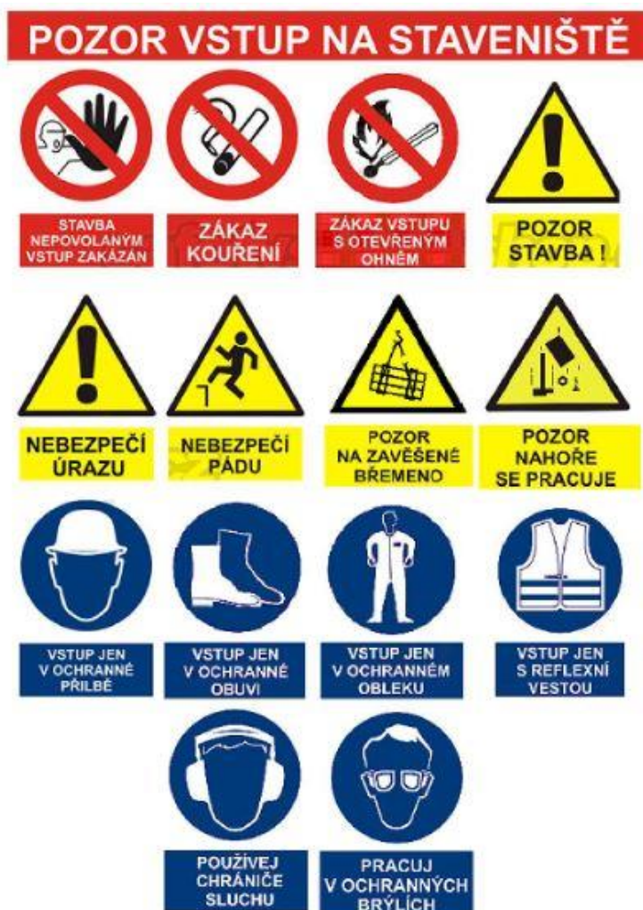
Obr. č.44 Informační tabule před vstupem na staveniště
