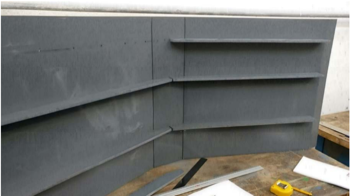
obr. 5.3 Fotografie zadní strany vrat s žebry [zdroj: autor]
