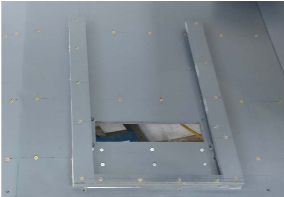
obr. 5.4 Fotografie přední strany vrat s otvorem, vodicími lištami a dosedacím prahem [zdroj: autor]
