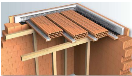
Obrázek 2.4.2-3-Postup realizace stropu Porotherm, krok 2
