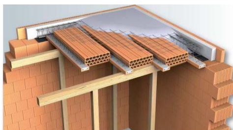
Obrázek 2.4.2-4-Postup realizace stropu Porotherm, krok 3
