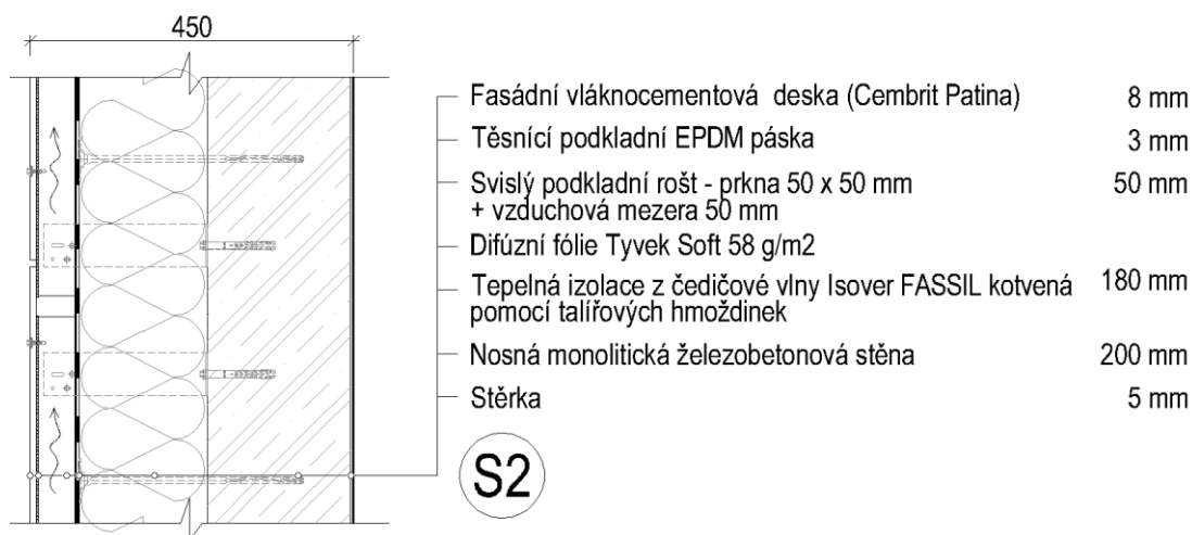
Obrázek 8: Skladba dvouplášťové obvodové stěny
