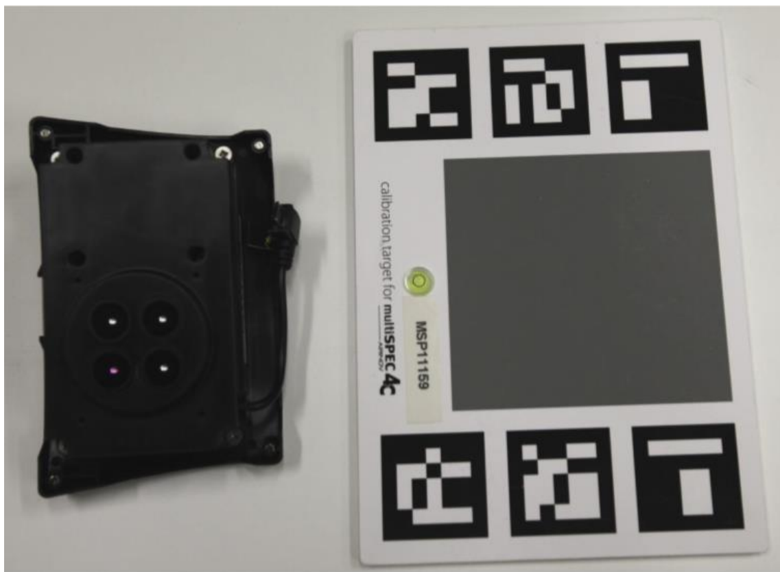
Obrázek 9 - kamera multiSPEC 4C a dodávané kalibrační pole
