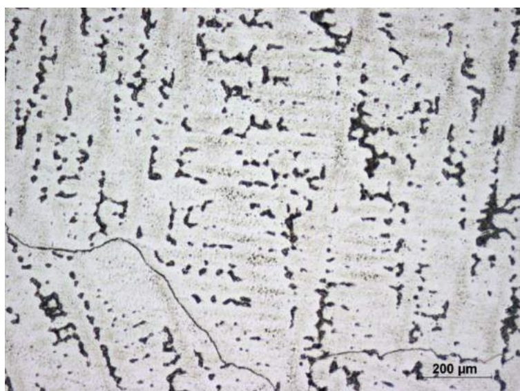
Obrázek 5.13: Slitina CoCr (kloubní náhrada), zvětšení 50x
