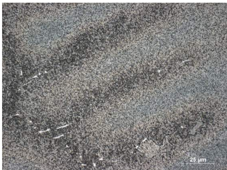
Obrázek 5.4: Slitina Inconel 713 LC tepelně zpracovaná, zvětšení 400x
