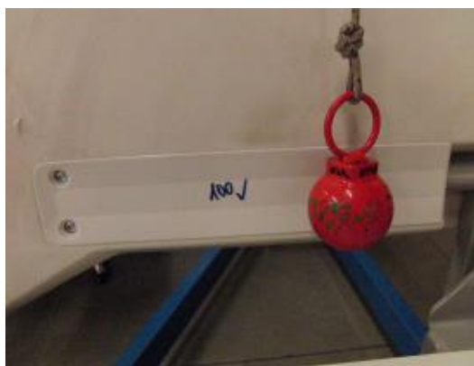
Obrázek 6.4: Detail nárazu ocelové koule do dílu
