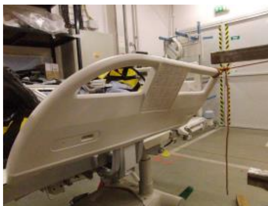
Obrázek 6.10: Zátížení postranice silon 1000 N vně lůžka
