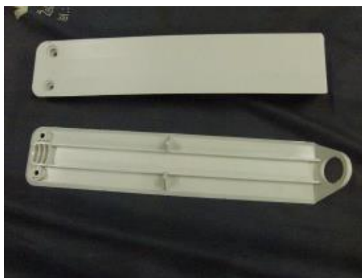
Obrázek 6.2: Testované díly z materiálu TABOREN-PC 72 T20
