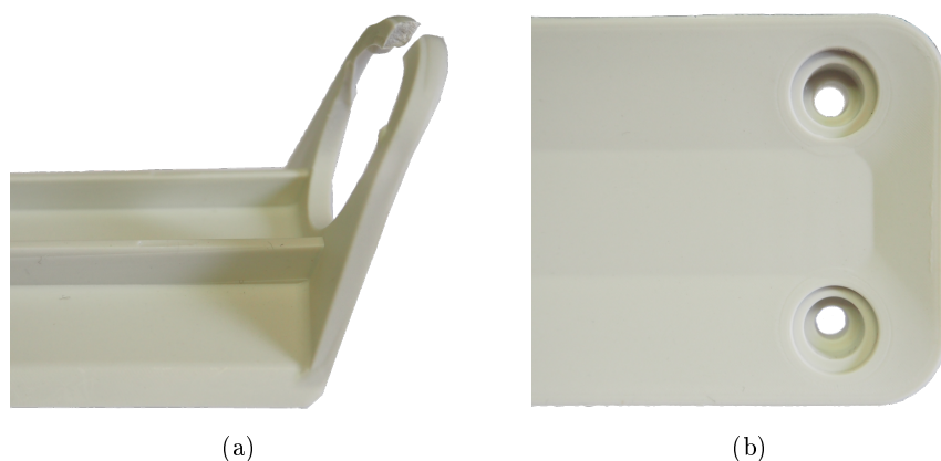
Obrázek 4.2: a) Studený spoj, b) Díry pro šrouby
