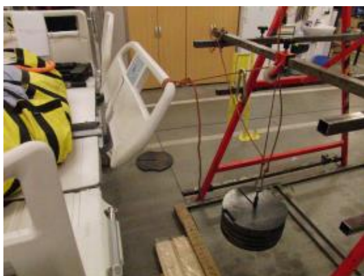
Obrázek 6.9: Zátížení postranice silon 900 N vně lůžka
