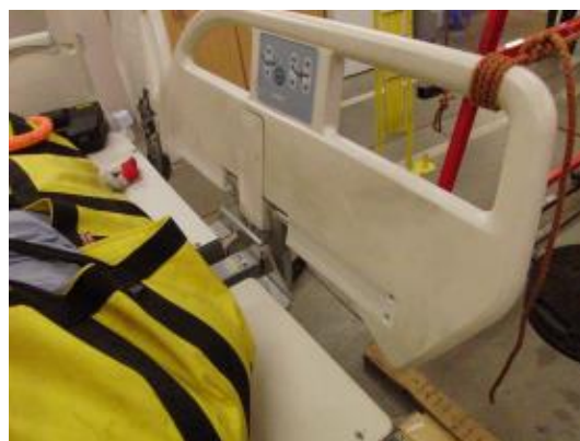
Obrázek 6.8: Detail postranice při zatížení silou 500 N
