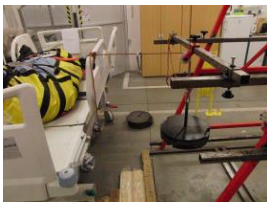
Obrázek 6.7: Zatížení postranice silou 500 N vně lůžka
