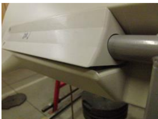
Obrázek 6.11: Detail dílu při zatížení postranice silou 1000 N
