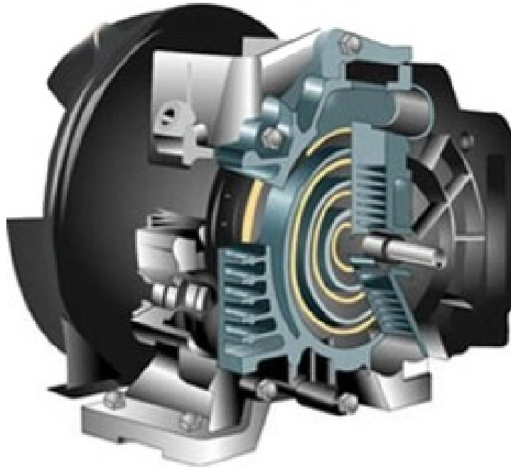
Obr. 6 Řez kompresorem scroll [11]
