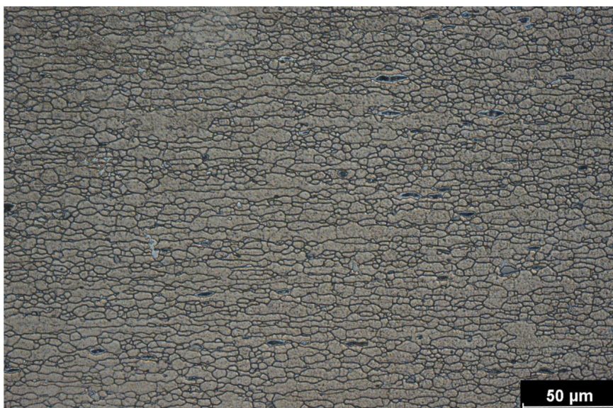
Obrázek A.18: Struktura slitiny EN AW-6082 v jádře
