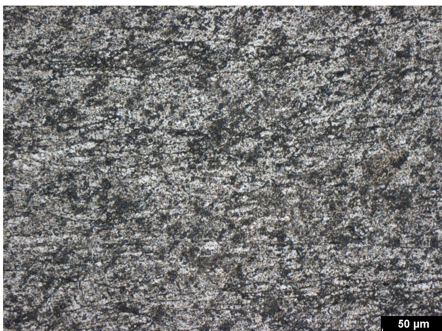
Obrázek A.14: Struktura v jádře HCM slitiny EN AW-6082 po deformaci (příčný řez)
