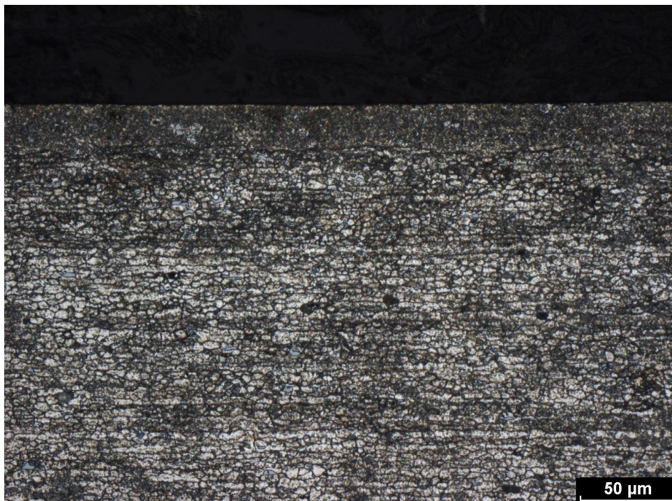
Obrázek 11.21: Struktura v oblasti povrchu lisované slitiny EN AW-6082 po deformaci (podélný řez)
