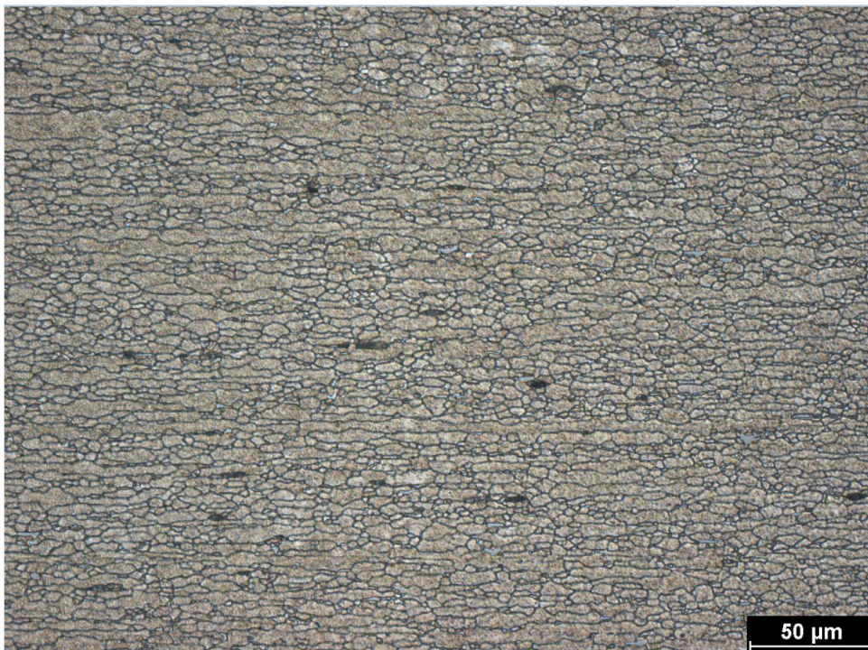
Obrázek 11.13: Detail struktury lisované slitiny EN AW-6082 v jádře
