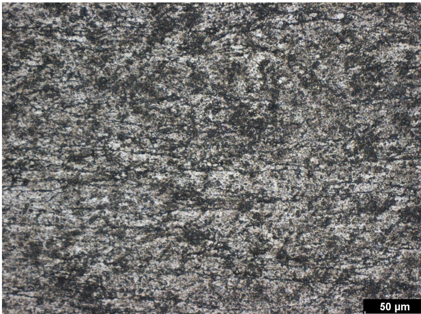
Obrázek 11.9: Struktura v oblasti jádra HCM slitiny po deformaci v oblasti (příčný řez)
