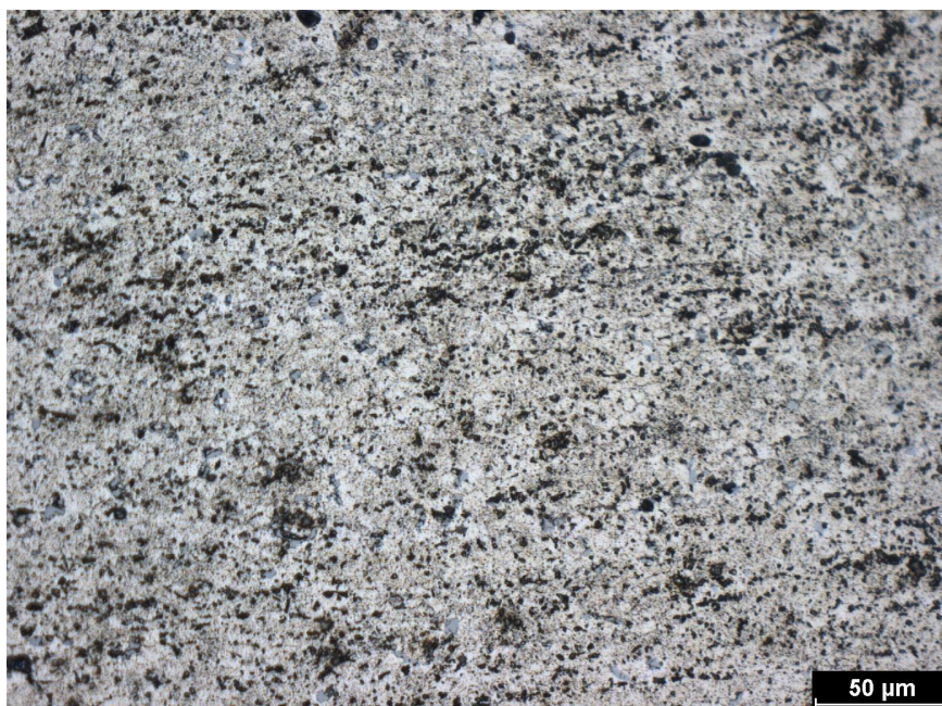
Obrázek A.29: Struktura v jádře slitiny EN AW-6082 po deformaci (příčný řez)
