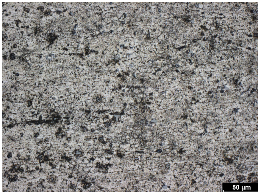
Obrázek A.28: Struktura v přechodové oblasti slitiny EN AW-6082 po deformaci (příčný řez)
