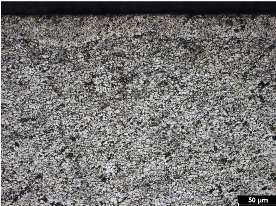
Obrázek 11.20: Struktura v oblasti povrchu lisované slitiny EN AW-6082 po deformaci (příčný řez)
