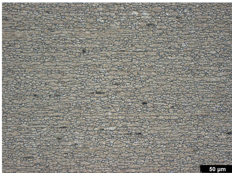
Obrázek A.17: Struktura slitiny EN AW-6082 v přechodové oblasti
