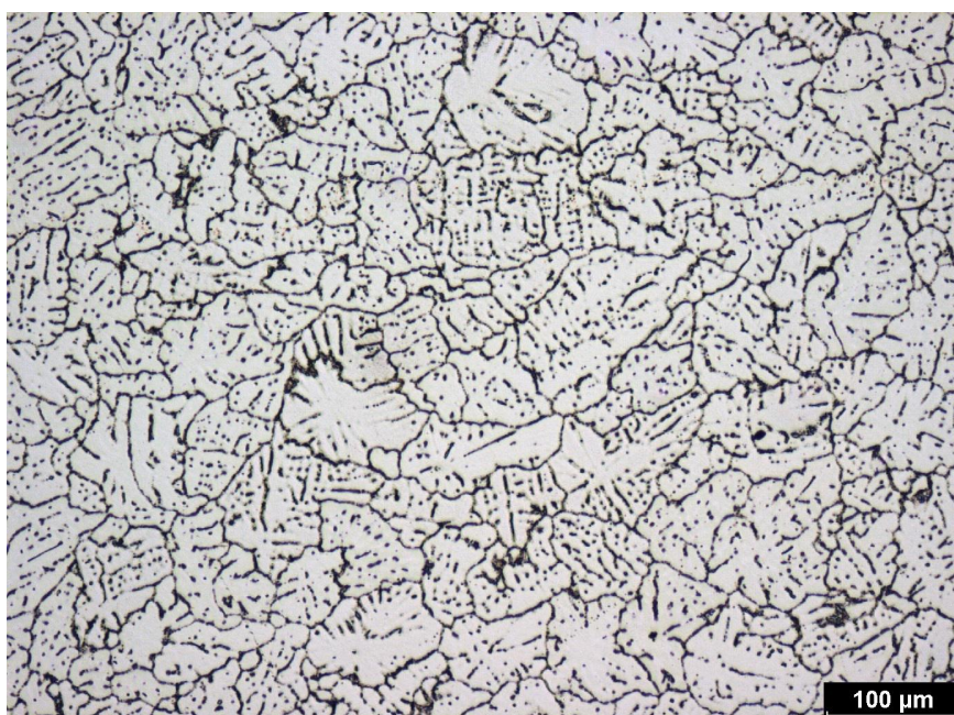
Obrázek A.8: Struktura v jádře HCM slitiny EN AW-6082 (podélný řez)
