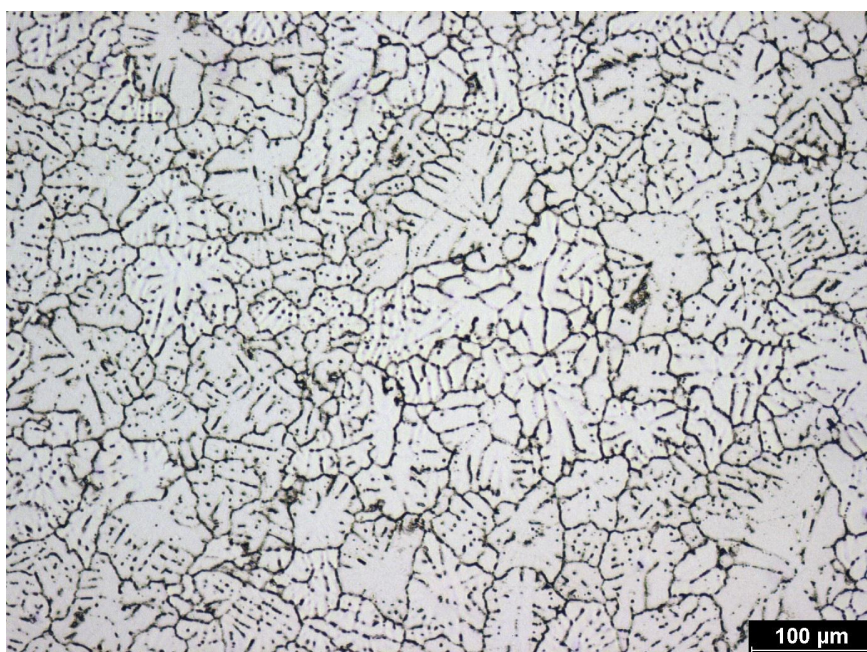
Obrázek A.6: Struktura v jádře HCM slitiny EN AW-6082 ve výchozím stavu (příčný řez)
