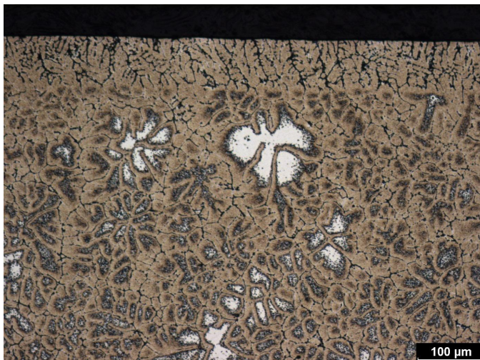
Obrázek 11.7: Struktura v oblasti povrchu HCM slitiny EN AW-6082 po ohřevu (podélný řez)
