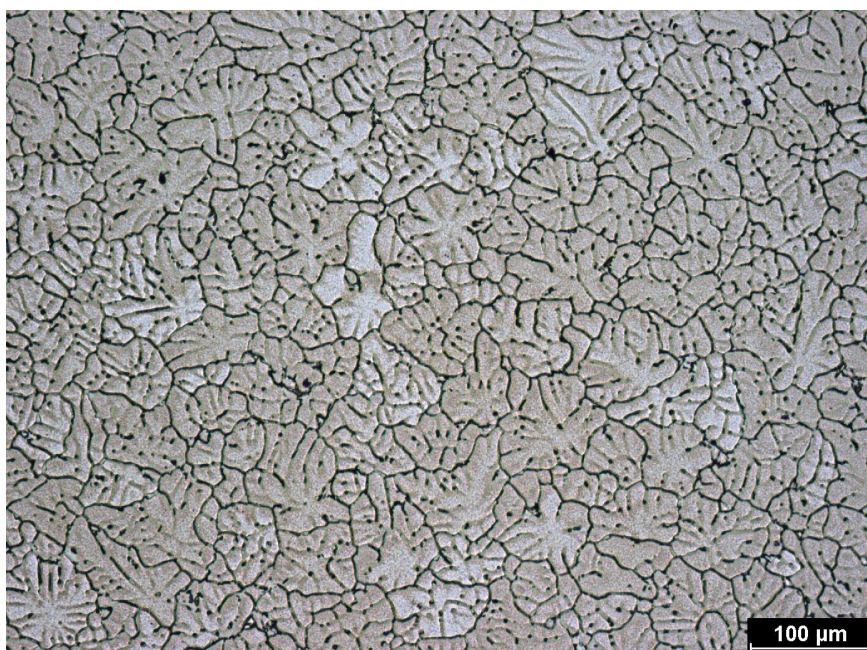
Obrázek A.3: Struktura HCM slitiny EN AW-6110A v přechodové oblasti
