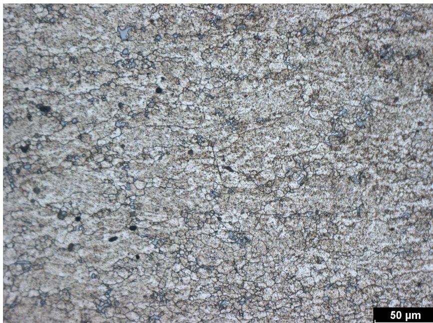
Obrázek A.20: Struktura v přechodové oblasti slitiny EN AW-6082 ve výchozím stavu (příčný řez)
