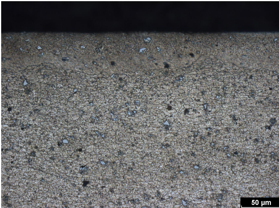
Obrázek 11.16: Struktura v oblasti povrchu lisované slitiny EN AW-6082 ve výchozím stavu (příčný řez)
