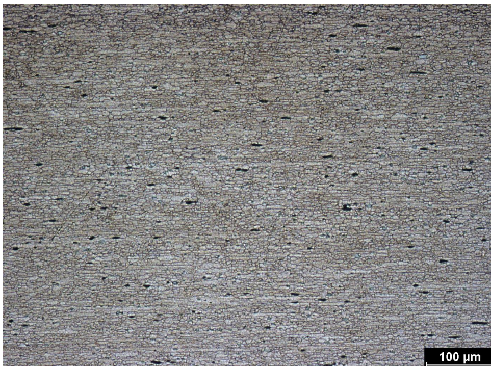
Obrázek 11.12: Struktura lisované slitiny EN AW-6082 v jádře
