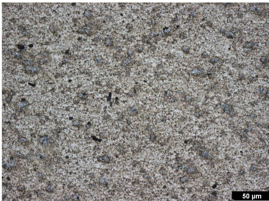
Obrázek A.22: Struktura v přechodové oblasti slitiny EN AW-6082 (podélný řez)
