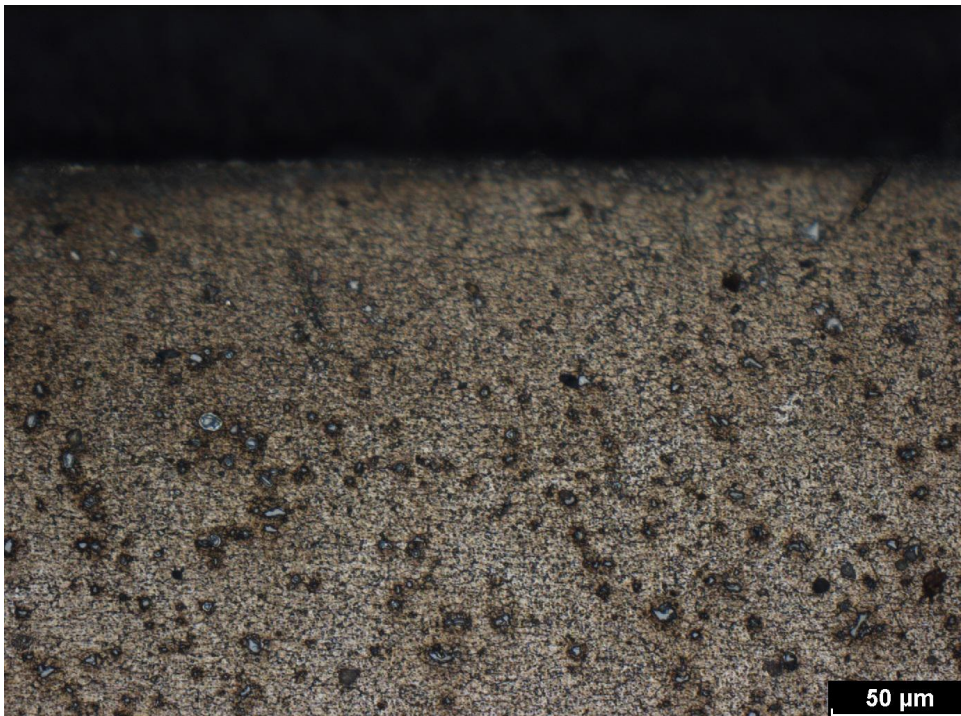
Obrázek 11.17: Struktura v oblasti povrchu lisované slitiny EN AW-6082 ve výchozím stavu (podélný řez)
