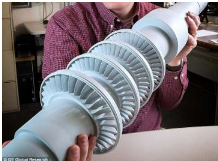
Obr. 3-10: Model sCO 2 turbíny společnosti GE vytvořený pomocí 3D tiskárny [34]
