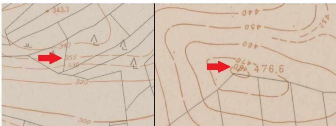
Obr. 4.10 Ukázka č. 1 špatně očíslovaných vrstevnic (vlevo – vznikl by hřbol, vpravo – vznikla by prohlubeň)
