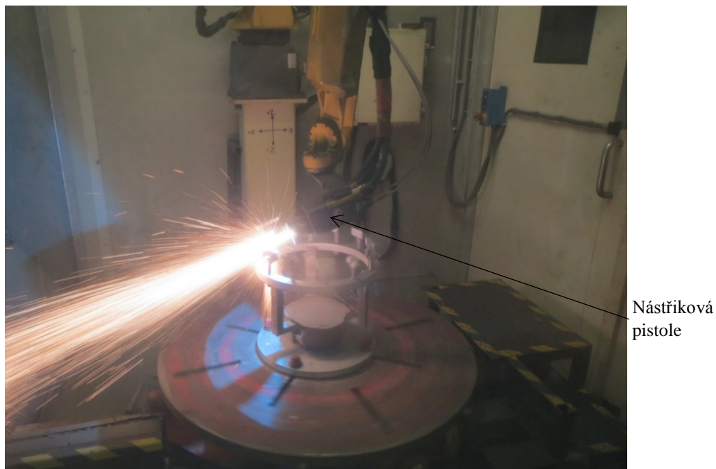
Obrázek 3.9: Průběh žárového nástřiku testovacích vzorků
