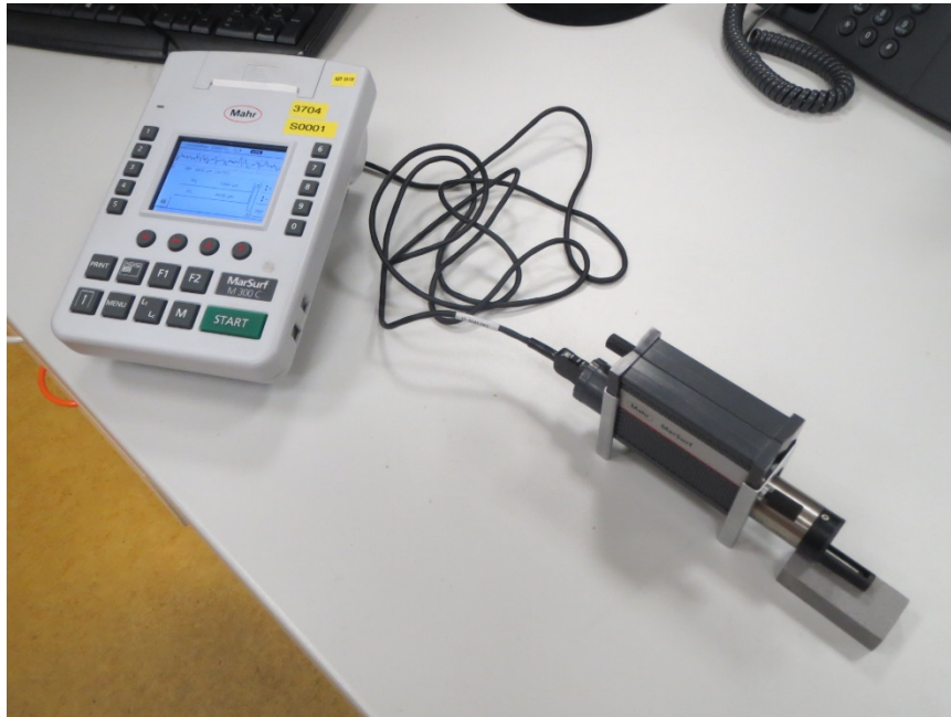
Obrázek 3.6: Měření drsnosti povrchu pomocí přístroje MarSurf M 300 C
