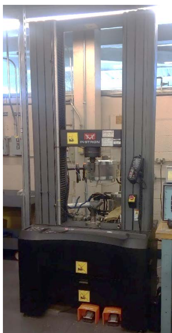
Obrázek 3.18: Univerzální trhací stroj INSTRON 5982 [19]
