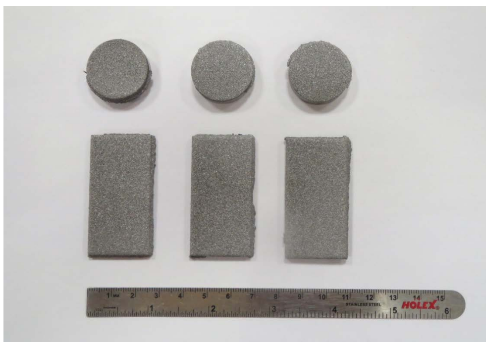
Obrázek 3.31: Zkušební vzorky FeCrAl na nerezovém podkladu po provedení žárového nástřiku
