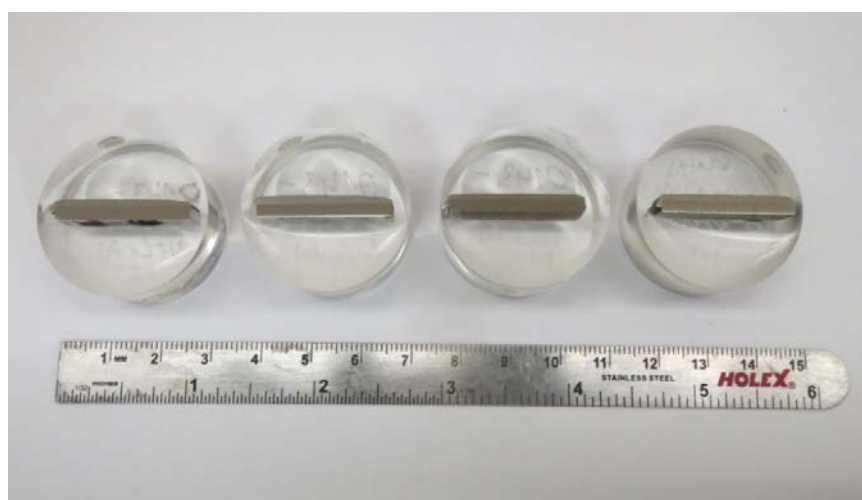
Obrázek 3.10: Vzorky připravené pro světelnou mikroskopii. Zleva: NiCrAl/nerez, FeCrAl/nerez, FeCrAl/litina, NiCrAl/litina
