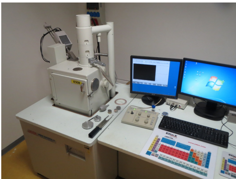
Obrázek 3.13: Elektronový mikroskop JEOL JSM-6460LV s energiově disperzním spektrometrem EDAX APOLLO XL
