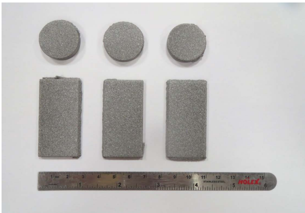
Obrázek 3.37: Zkušební vzorky FeCrAl na litinovém podkladu po provedení žárového nástřiku
