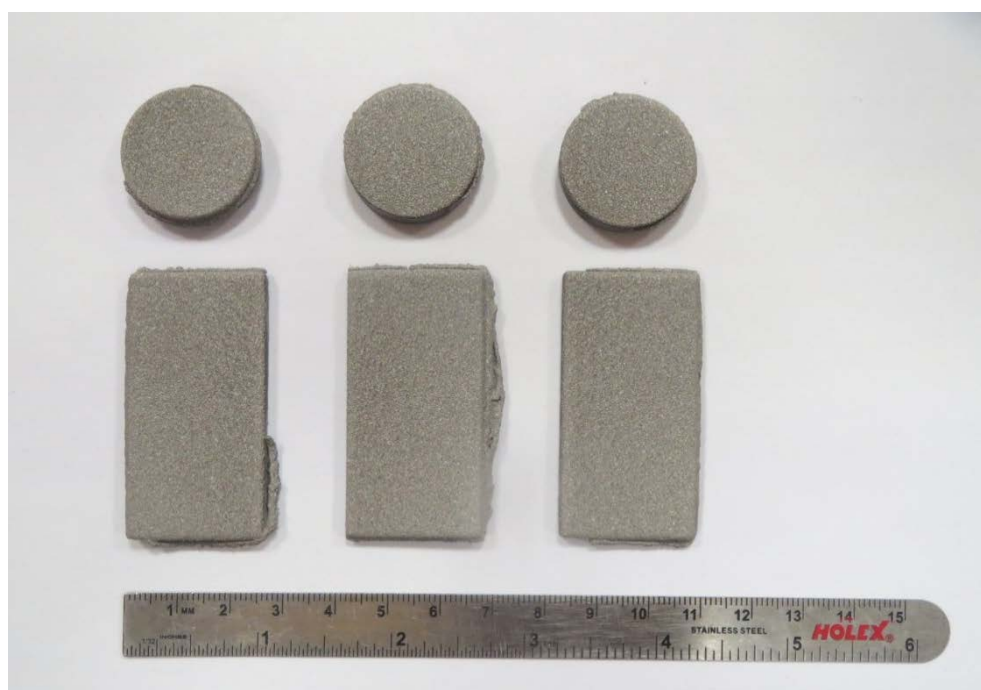
Obrázek 3.25: Zkušební vzorky NiCrAl na litinovém podkladu po provedení žárového nástřiku
