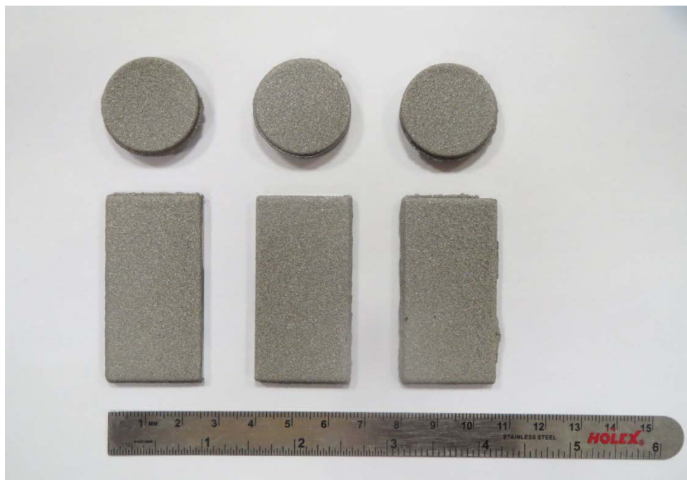
Obrázek 3.19: Zkušební vzorky NiCrAl na nerezovém podkladu po provedení žárového nástřiku
