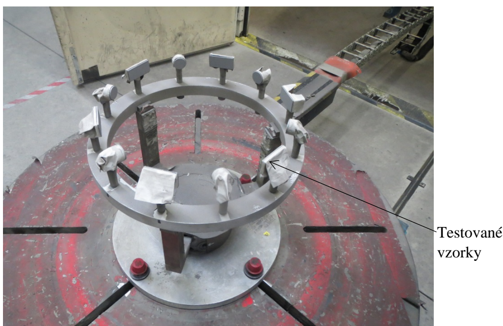
Obrázek 3.8: Přípravek s testovacími vzorky upevněný k rotačnímu stolu
