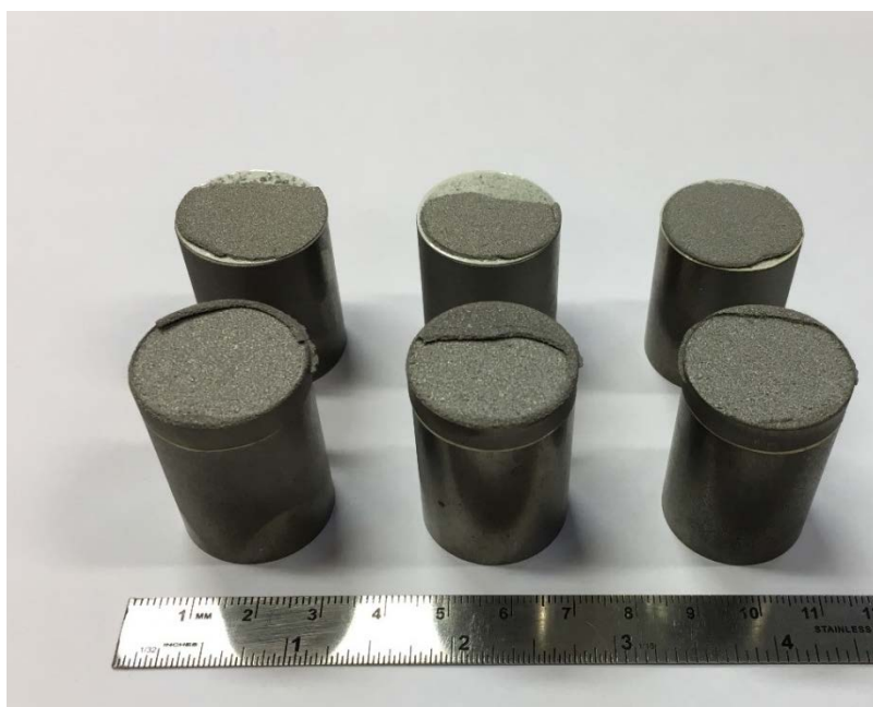
Obrázek 3.30: Zkušební vzorky s nástřikem NiCrAl na litinovém podkladu po provedení zkoušky přílnavosti
