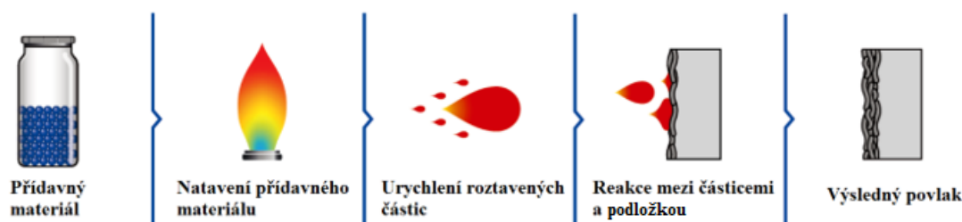
Obrázek 2.15: Proces žárového nástřiku [17]
