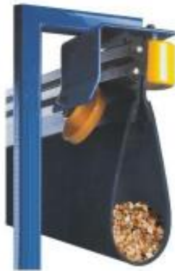
Obr. 8: Ukázka dopravníku s ohnutým gumovým pásem [10]
