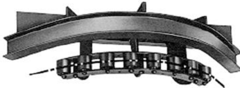
Obr. 23: Opěrné vodící kolo se soustavou podpůrných válečků [19]
