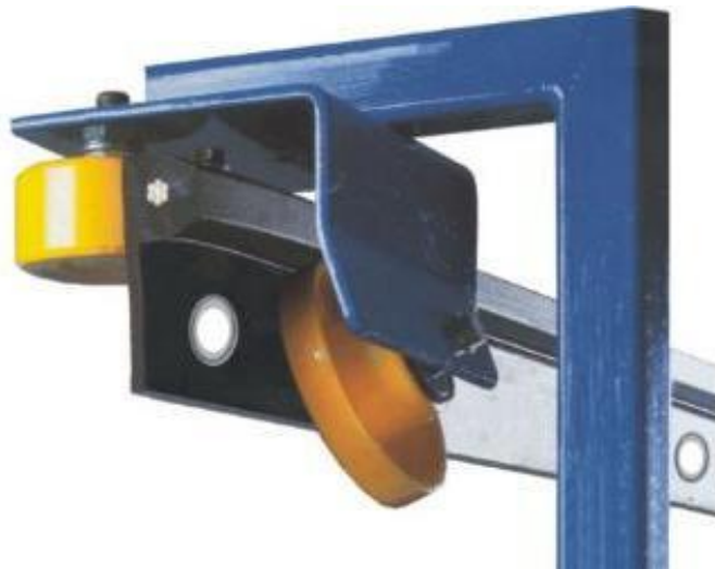
Obr. 7: Ukázka dopravníku s tažným gumovým členem [10]
