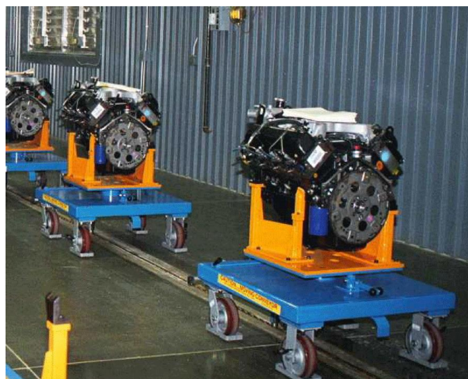
Obr. 9: Ukázka dopravníku s břemenem nad osou tažného členu [11]
