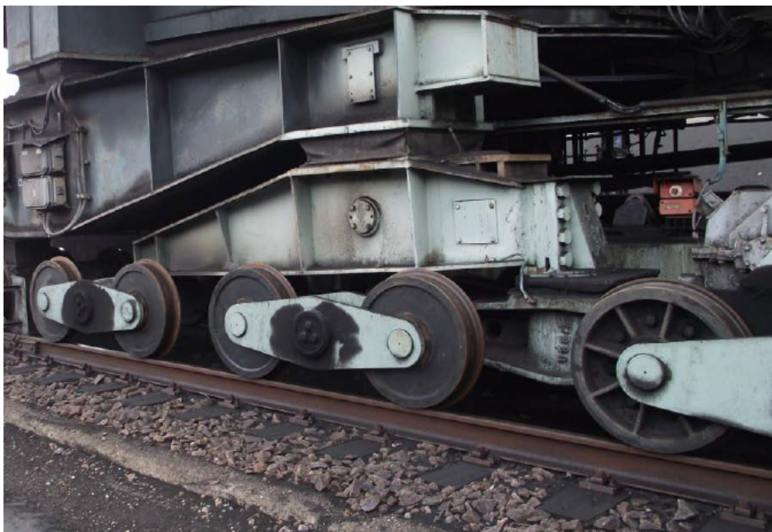
Obrázek 11: Vahadlo s vidlicovou konstrukcí Zdroj: [4]
