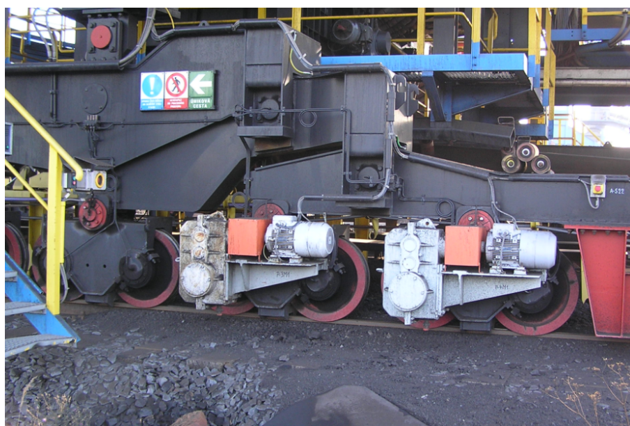
Obrázek 18: Elektromechanický pohon umístěný přímo na hnaném kole Zdroj: [15]
