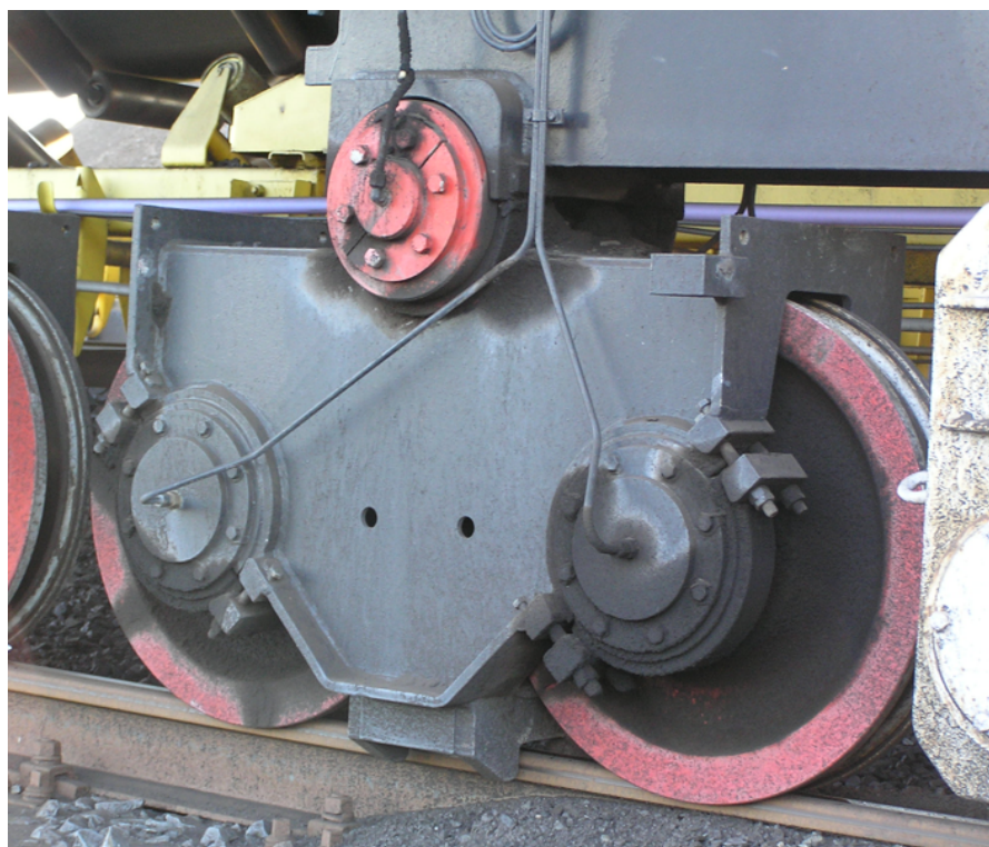
Obrázek 12: Uložení kol v třmenech Zdroj: [15]
