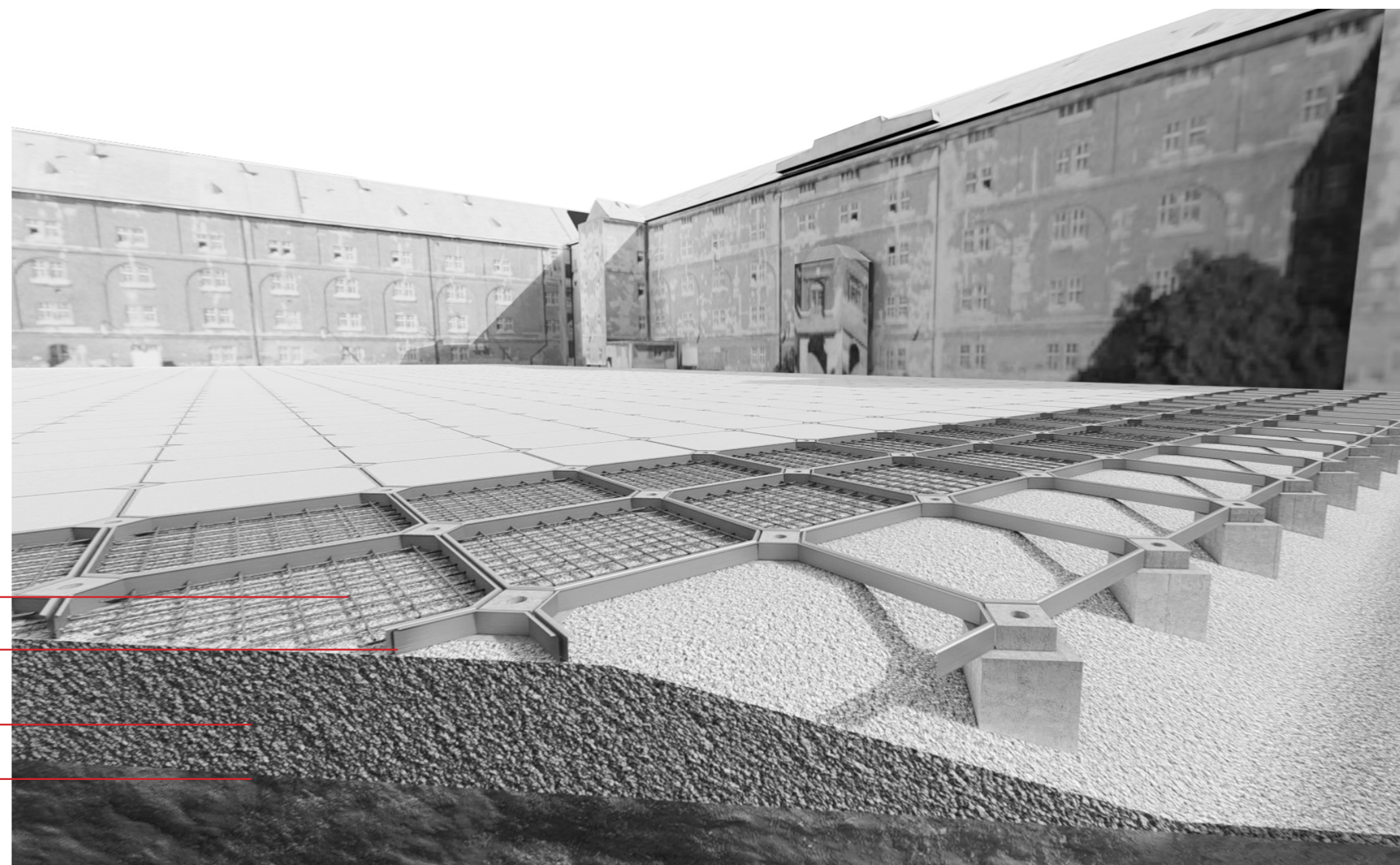
Vizualizace ocelového bednění a jednotlivých vrstev dlažby
