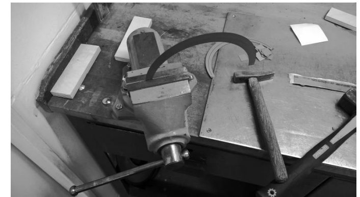
Obr. 11, 12, 13, 14 – ohýbání plechu na dílenském svěráku
