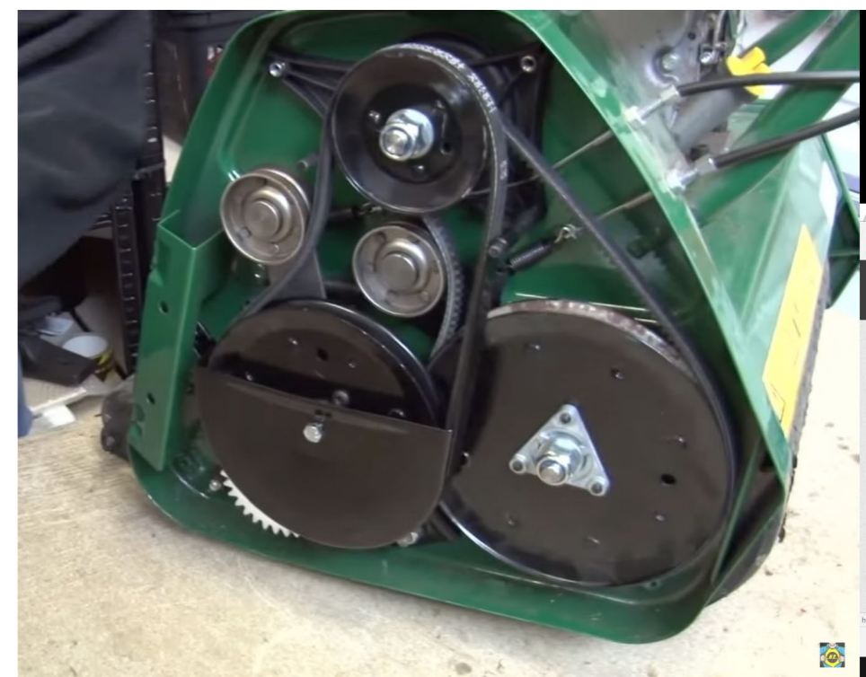
Allett Kensington - benzínová vřetenová sekačka, bok bez krytu
