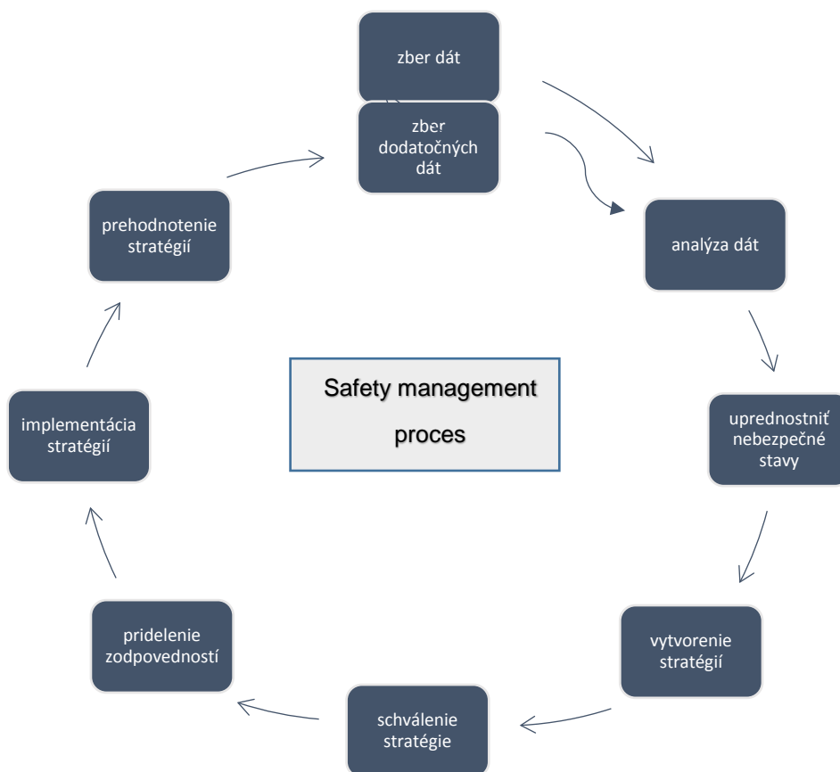
Obrázok 2 - Proces riadenia bezpečnosti ICAO (zdroj: Alan J. Stolzer, John J. Goglia: Safety Management Systems in Aviation )
