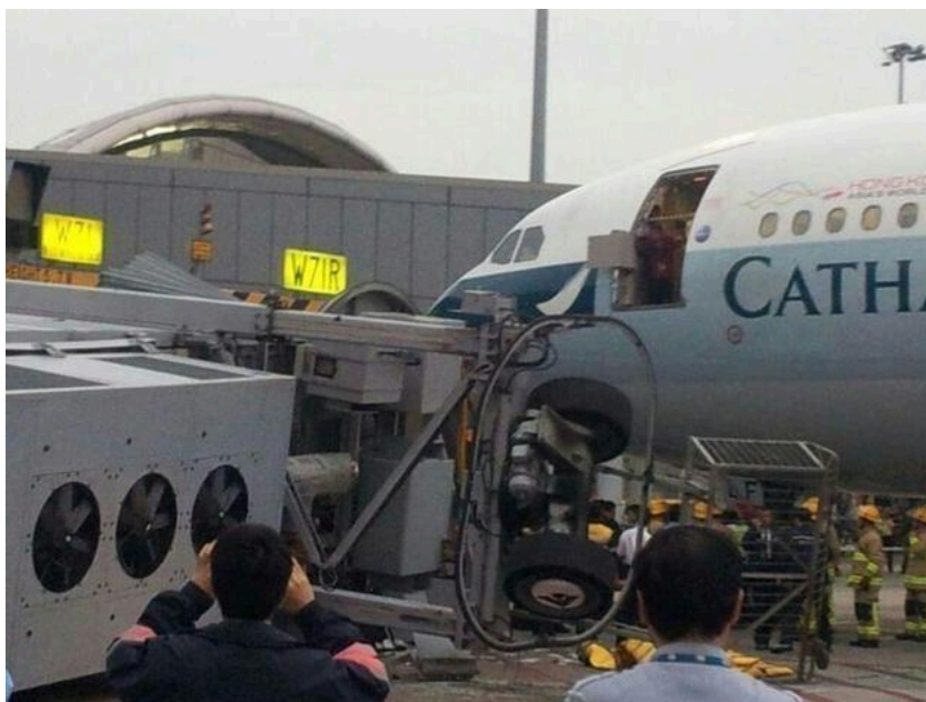
Obrázok 13 - Zrútenie nástupného mostu (zdroj: (29))
