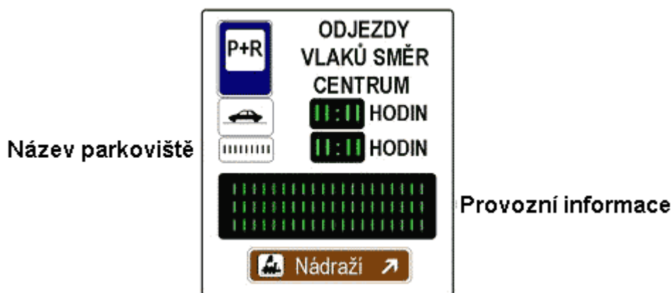
obr. 6: Příklad řešení proměnné informační tabule k záchytnému parkovišti P+R [34]
