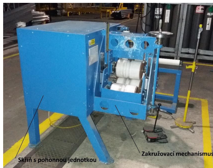
obr. 13: Současný stav zakružovačky [1]
