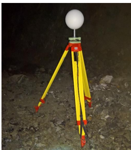
Obrázek 8 Kulový terč 200 mm na stativu
