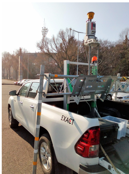
Obrázek 7.3: Připevněný skener na stanovisku s nucenou centrací
