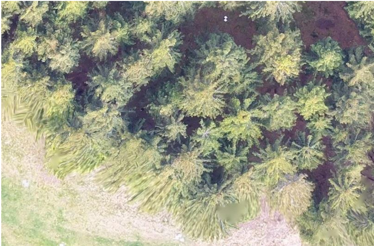
Obr. č. 43: Slabší kvalita částí ortofota z dat RPAS ve výšce 90 m nad terénem
