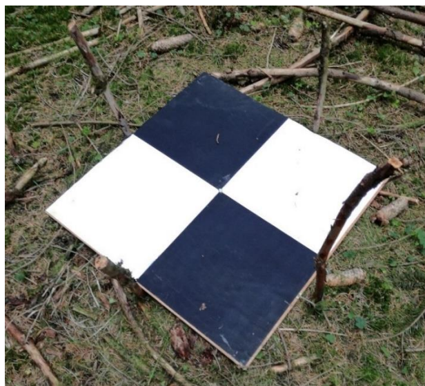
Obr. č. 8: Vlíčovací bod v terénu
