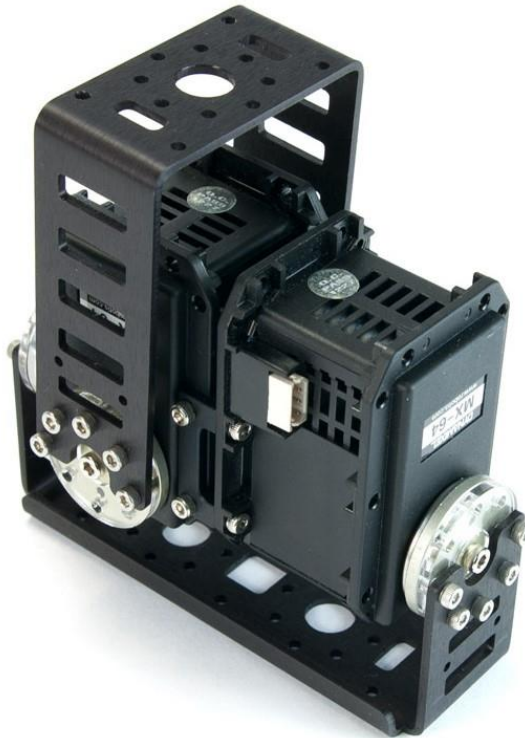
Obr. 11: Kloub se 2 stupni volnosti pomocí servomotorů [12]
