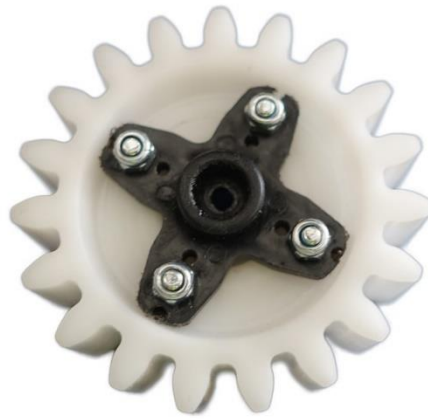
Obr. 34: Pastorek P2019 se servopákou loketního kloubu
