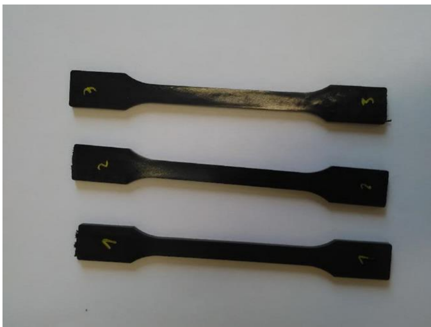
Obr. 16 - Zkušební tělíska z PA 6 + PA 66 + 30 GF, autor fotografie: Antonín Voldřich
