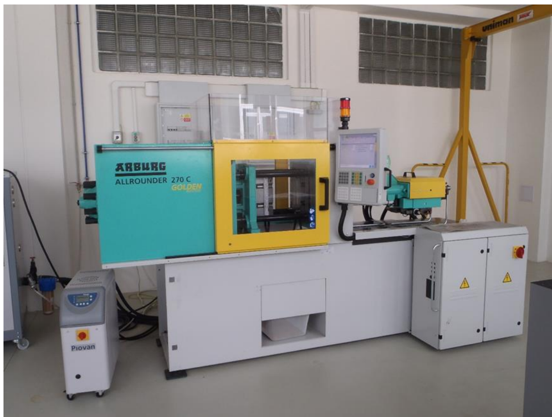
Obr. 17 - Vstřikovací stroj ALLROUNDER 270C, autor fotografie: Antonín Voldřich
