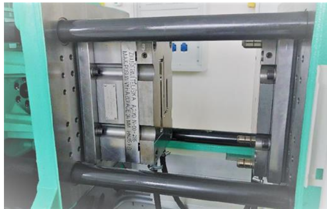
Obr. 10 - Vstřikovací forma, autor fotografie Antonín Voldřich
