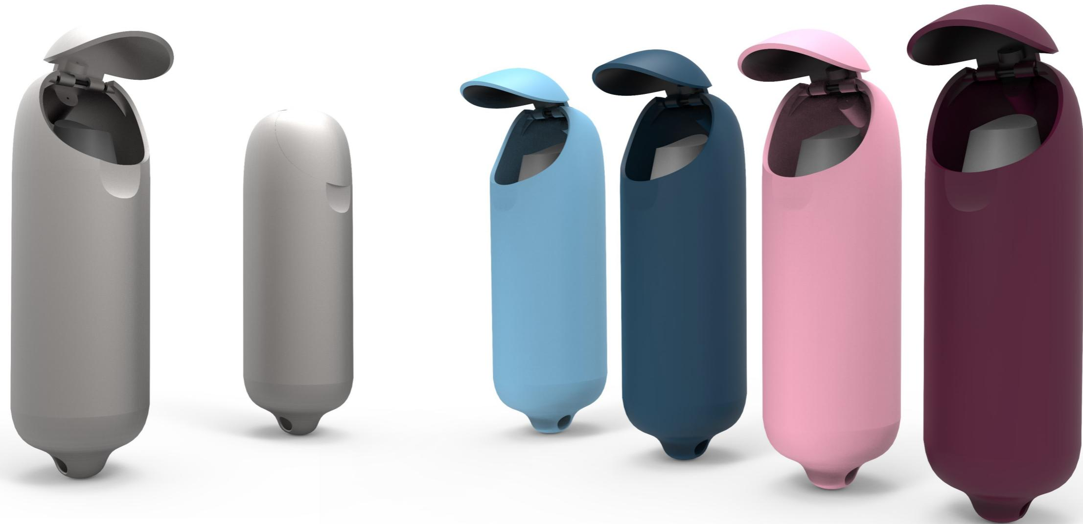
Objem mnou zvolené bombičky je 50 ml s dosahem tří metry a obsahuje látku ve formě aerosolu. Je ale možné do pláště umístit nádobku s jiným obsahem. V rozměrech výrobku jsem se příliš neodchylovala od stávajících malých sprejů, neboť jsou velké akorát do ruky. Tloušťka stěny je u hliníkového pláště 1 mm, u plastového 1,5 mm (v závislosti na tvrdosti použitého plastu). Jednotlivé konstrukční části mechanismu na otevírání pojistky (pérko a tyčka na otáčení) jsou kovové.
