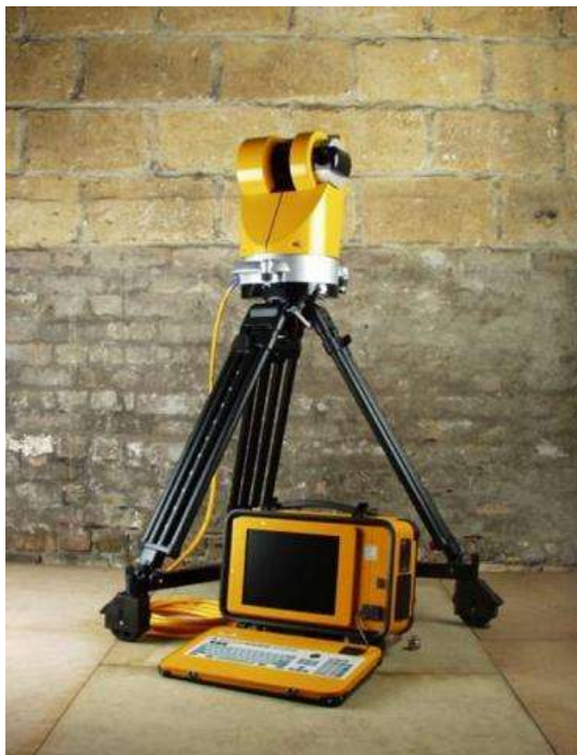
Obr. 8 Laserový skener Callidus CP 3200 [10]
