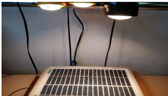
Obrázek č.6.3. Tři žárovky, každá o výkonu 40W
