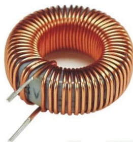
Obrázek č. 1.4.1. Toroidní cívka o indukčnosti 25mH [17]
