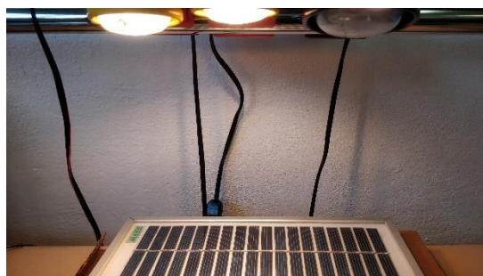
Obrázek č.6.4. Dvě žárovky, každá o výkonu 40W
