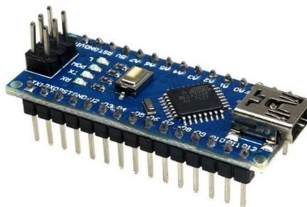
Obr 5 – Základní deska Arduino nano [2]
