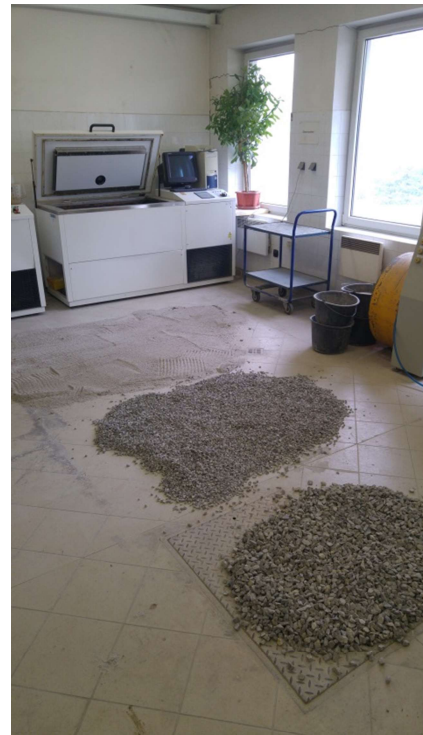
Obr. 42 Vysychající navážka kameniva pro plánované záměsi
