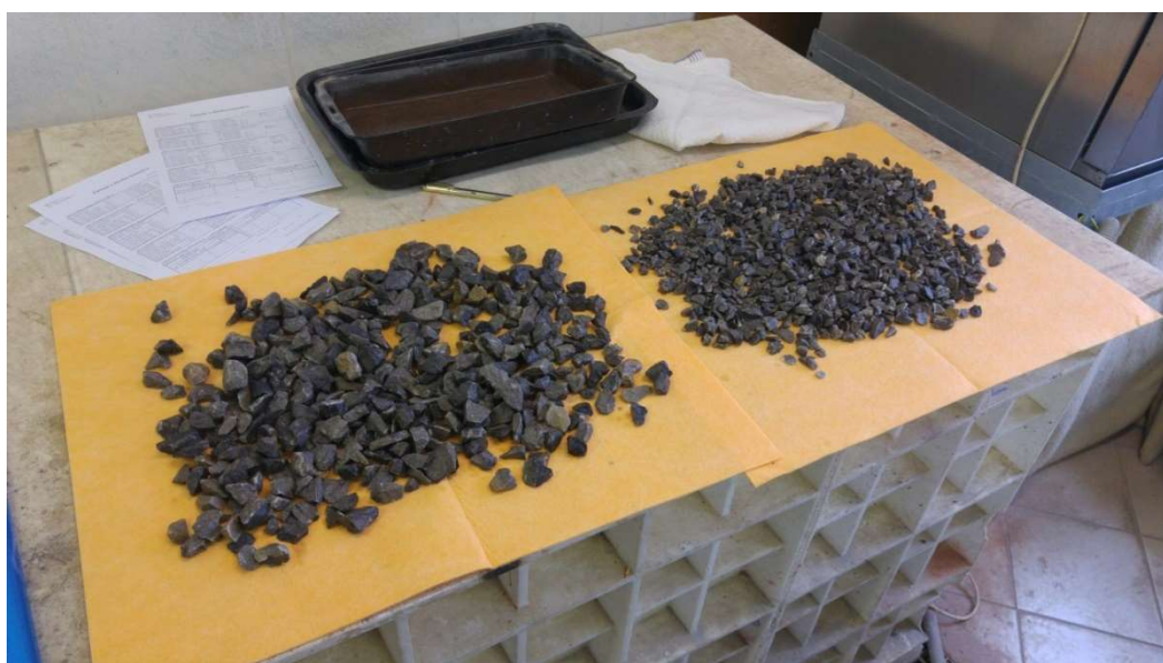
Obr. 28 Kamenivo frakce 8/16 a 11/22 ponecháno povrchově uschnout na suchých utěrkách
