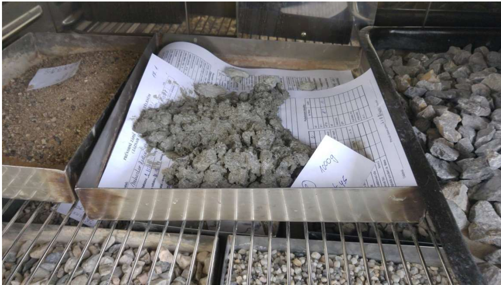
Obr. 33 Vysoušení zkušební vzorku v sušárně o teplotě 110 °C
