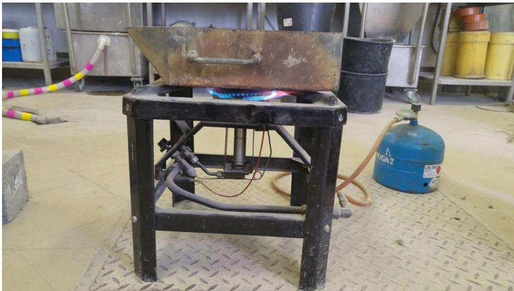
Obr. 34 Vysoušení zkušební vzorku nad plynovým hořákem
