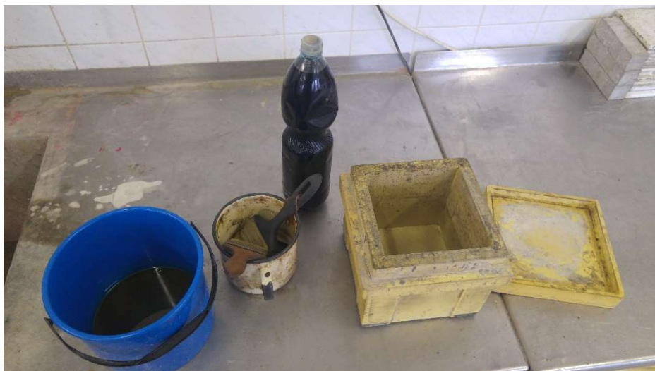
Obr. 43 Vymazávání forem odbedňovacím prostředkem
