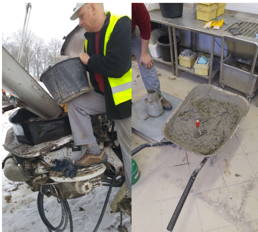
Obr. 47, 48 Vlevo odběr vzorku na stavbě, vpravo připravená betonové směs na zkoušky po přepravě zpět do laboratoře
