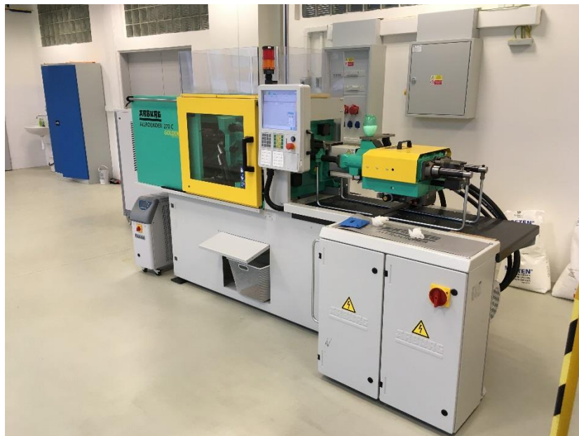
Obrázok 36: Vstrekovací stroj Arburg ALLROUNDER 270 C. Autor fotografie: Martin Lipták
