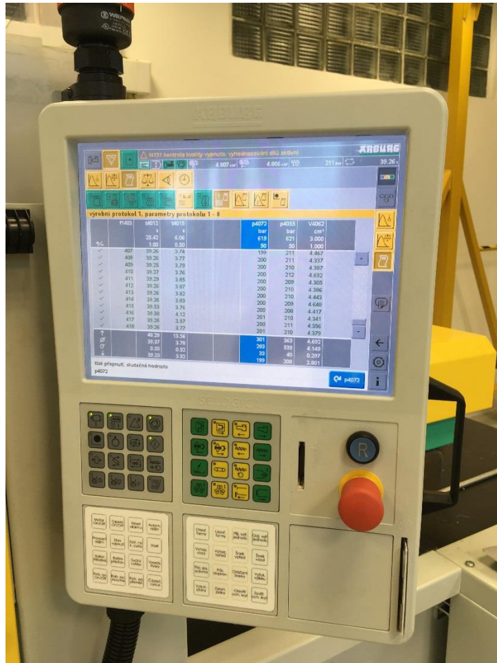
Obrázok 38: Ovládací panel stroja SELOGICA vstrekovacieho stroja Arburg ALLROUNDER 270 C Autor fotografie: Martin Lipták
