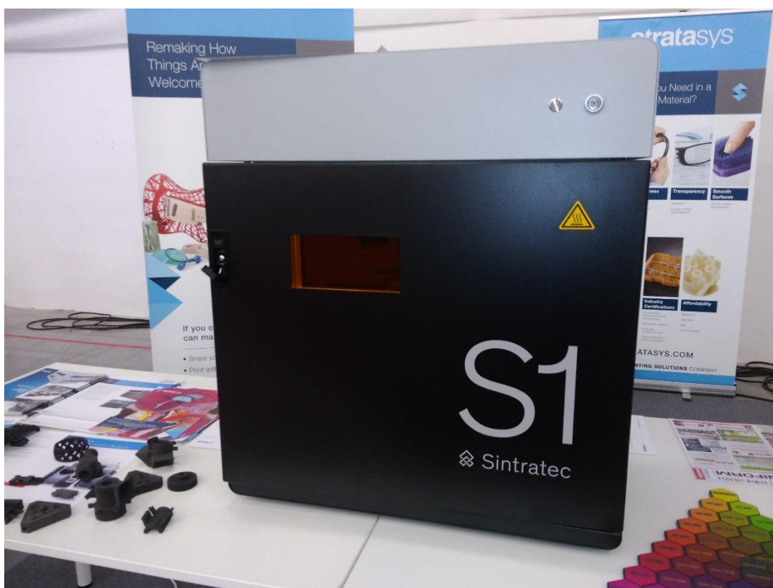
Obr. 1 – Komerční prášková SLS tiskárna Sintratec S1. Disponuje tiskovým prostorem 130 x 130 x 180 mm. Je zde využit diodový laser o výkonu několika wattů. Cena se pohybuje okolo 9000 €.
