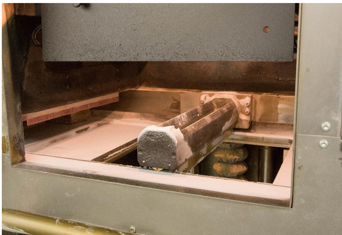
Obr. 11 – mechanismus nanášení vrstvy prášku
