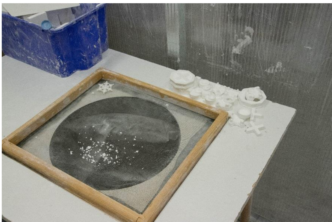
Obr. 12 – nádoba se sítím pro oklepání nespečeného prášku z výtisku
