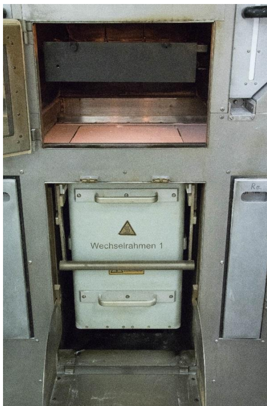
Obr. 10 – tisková komora s tiskovou plochou a nádobou s vytištěným produktem
