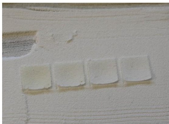
Obr. 22 – Pokus Al-B – tisk „do prášku“
