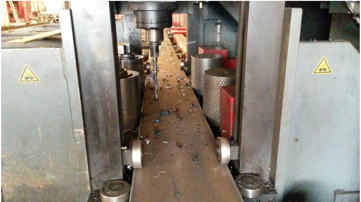
Obrázek 12: Vrtání na pilovrtacím centru
