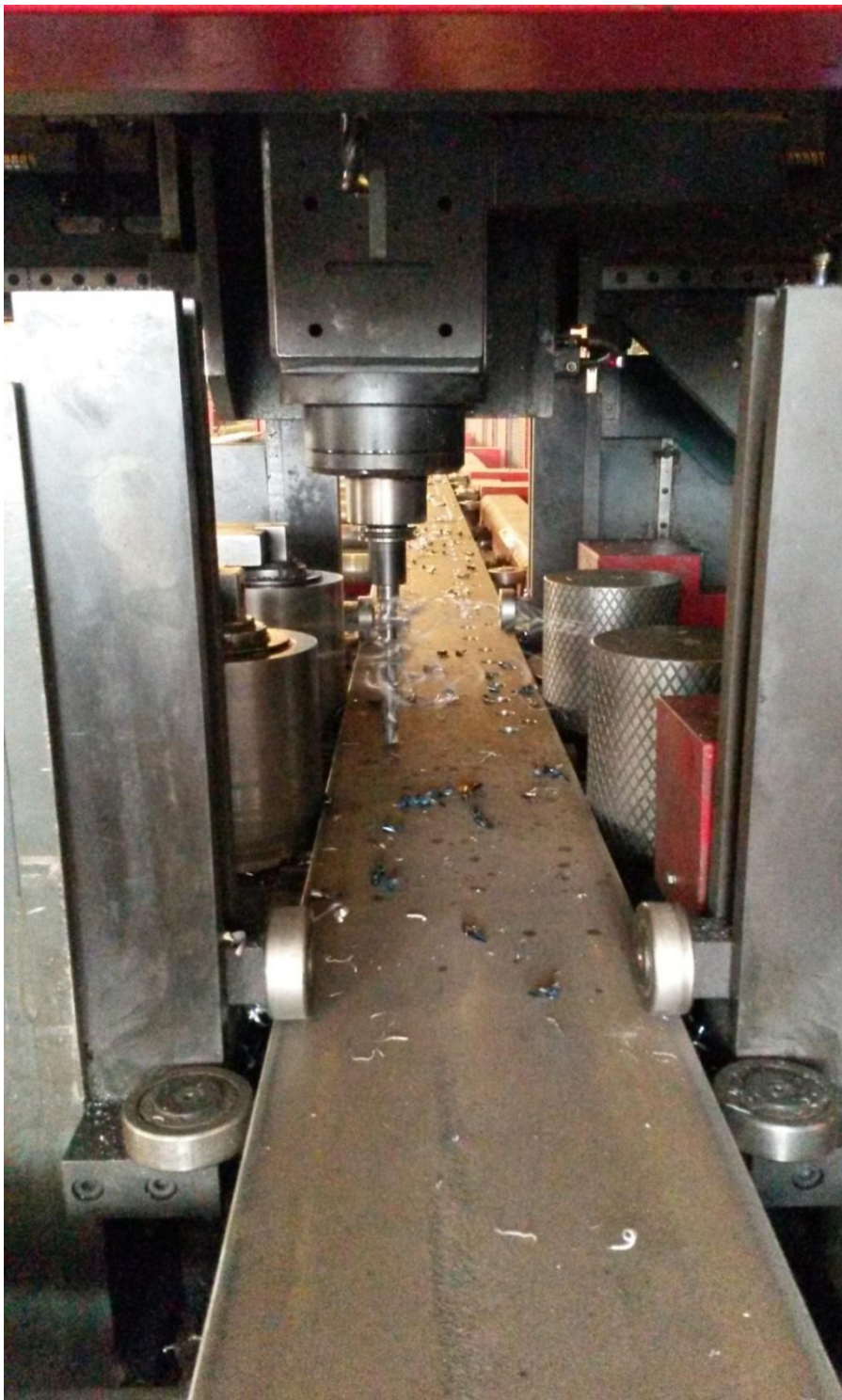
Obrázek 11: Vrtání na pilovrtacím centru
