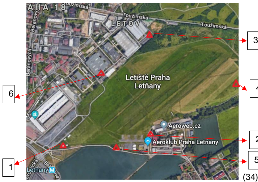
Obrázek 42 – Odhad předpokládaného rozmístění přijímačů na LKLT
