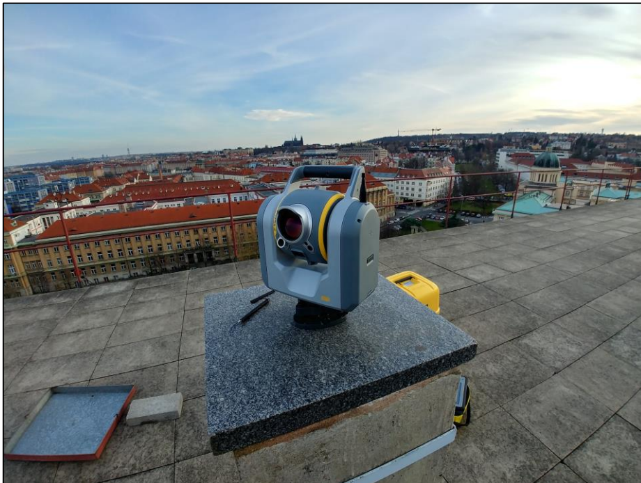
Obr. 5: Trimble SX10 na pilíři
