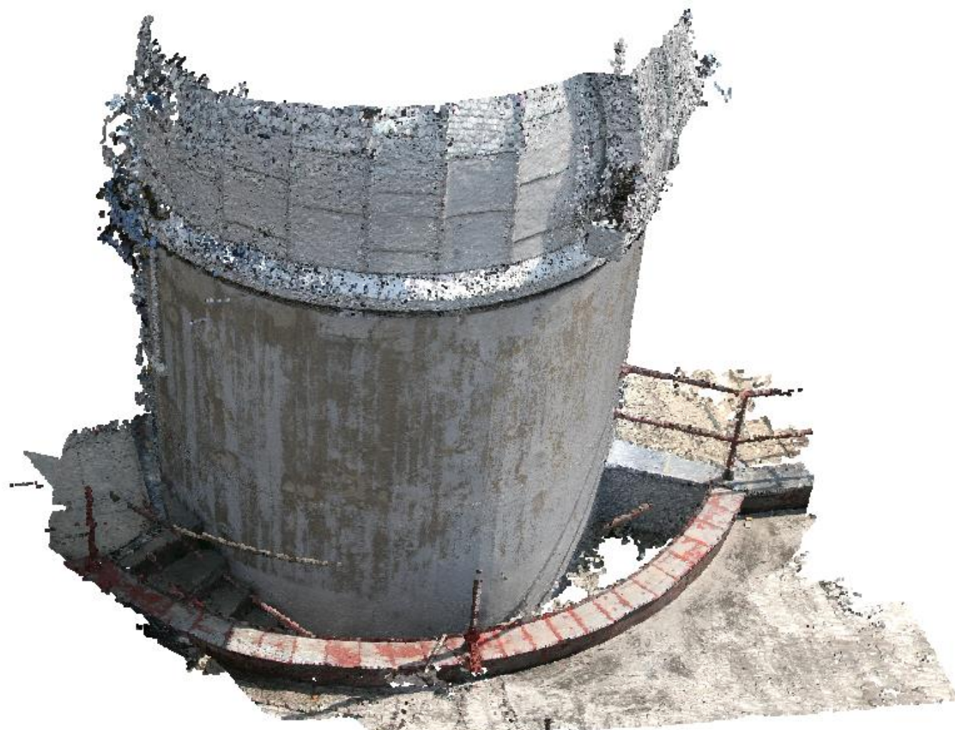
Příloha č. 4: Mračno bodů vytvořené ze snímků pořízených fotoaparátem
