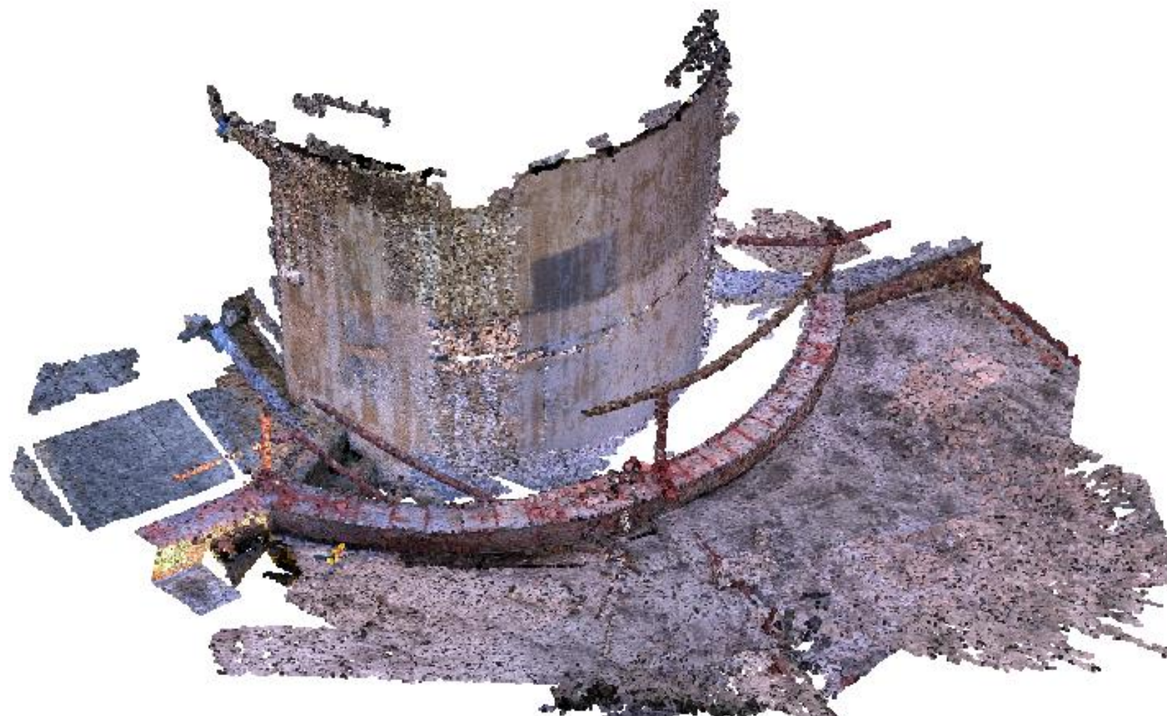
Příloha č. 5: Mračno vytvořené ze snímků pořízených totální stanicí
