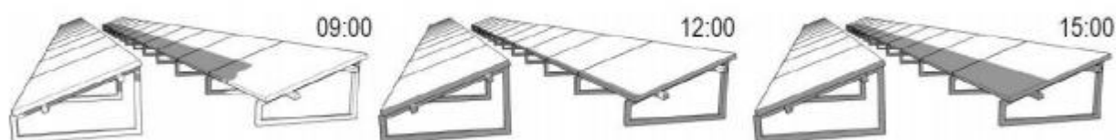
Obr. 14: Vzájemné stínění FV modulu [15]
