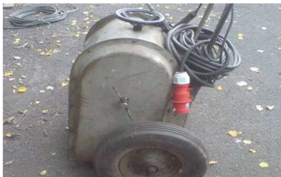
Obr. 3 zdroj svařování - transformátor
