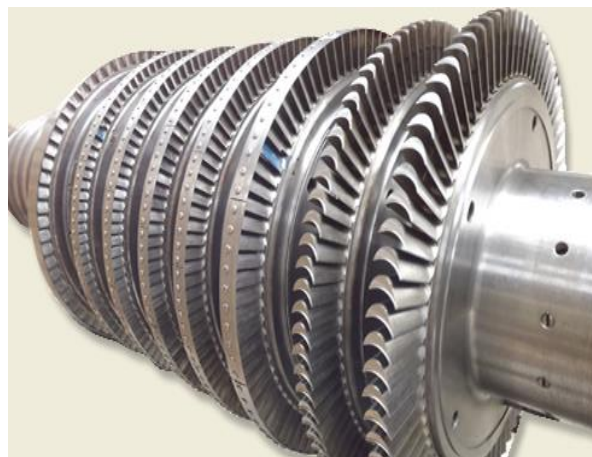
Obrázek 4 – Příklad použití nalisovaných spojů – rotor turbíny
