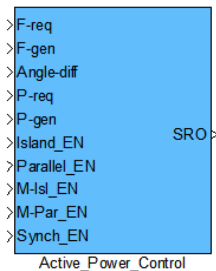
Obrázek 3.3: Funkční blok řízení aktivního výkonu
