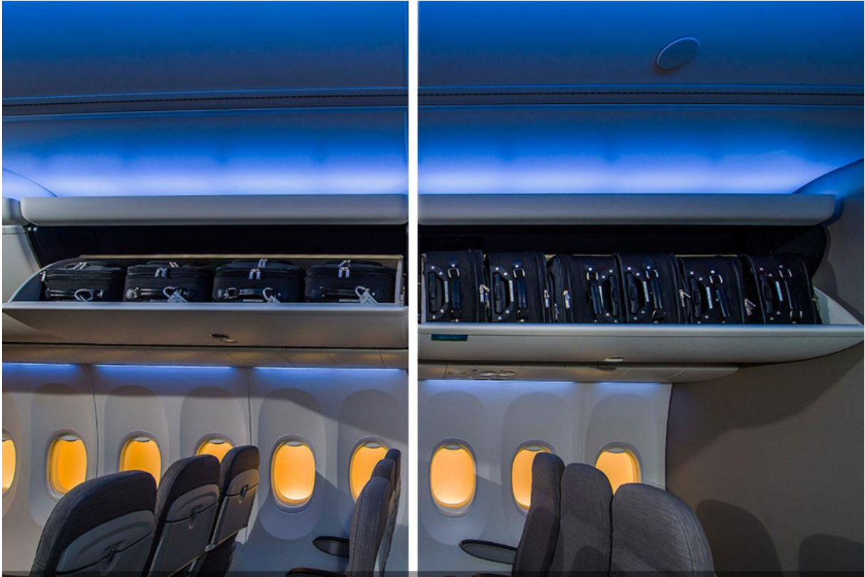
Obrázek 10 - Rozšířená konfigurace prostorů pro palubní zavazadla (Zdroj: Boeing)
