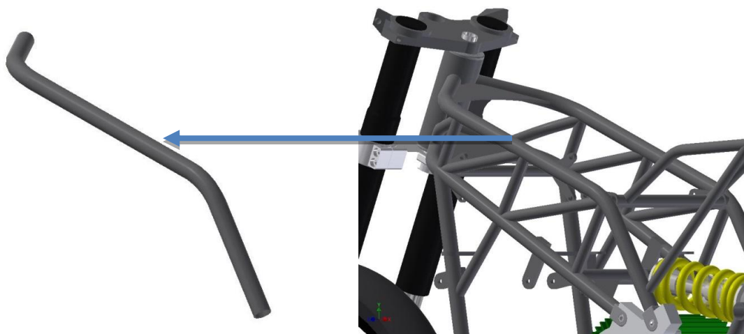
Obrázek 12 - Trubková konstrukce rámu [Zdroj: archiv týmu CTU Lions Electric]
