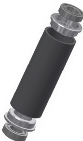
Obrázek 11 - Sestavení hlavy řízení [Zdroj: archiv týmu CTU Lions Electric]
