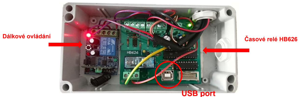
Obr. [2] Zapojení časovače a dálkového ovládání v krabičce s vyznačeným USB portem
