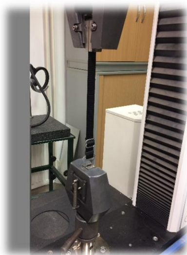
Obrázek 38: Druhý vzorek se sponou, přezkou a švy
