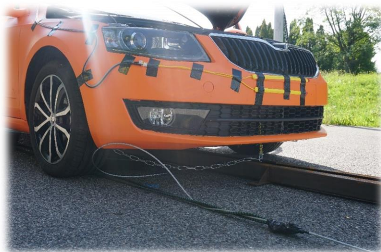
Obrázek 9: Uchycení testovaného vozidla do kolejnice
