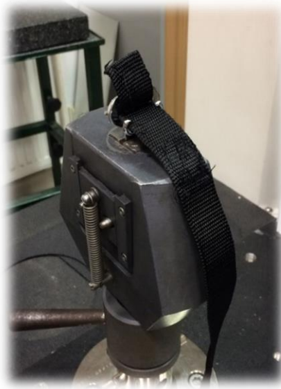
Obrázek 41: Vzorek číslo tři po dokončení tahové zkoušky
