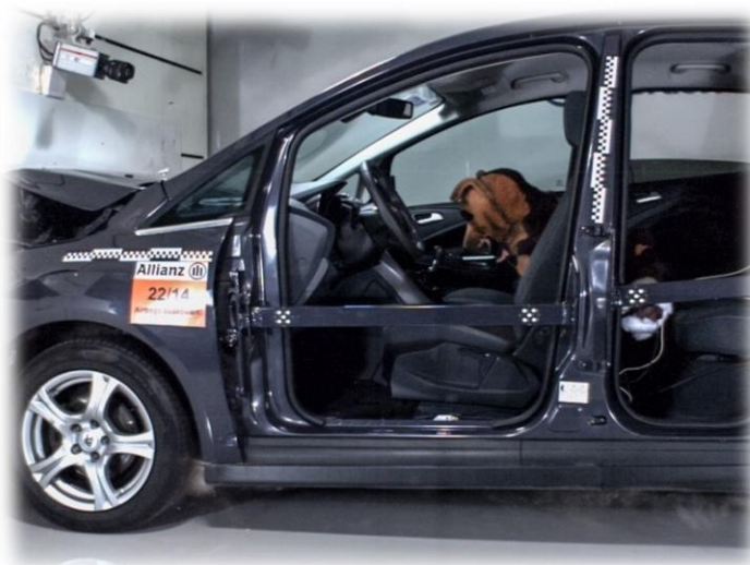
Obrázek 5: Záběr vymrštění nezajištěného psa při crash testu vysokorychlostní kamerou [11]
