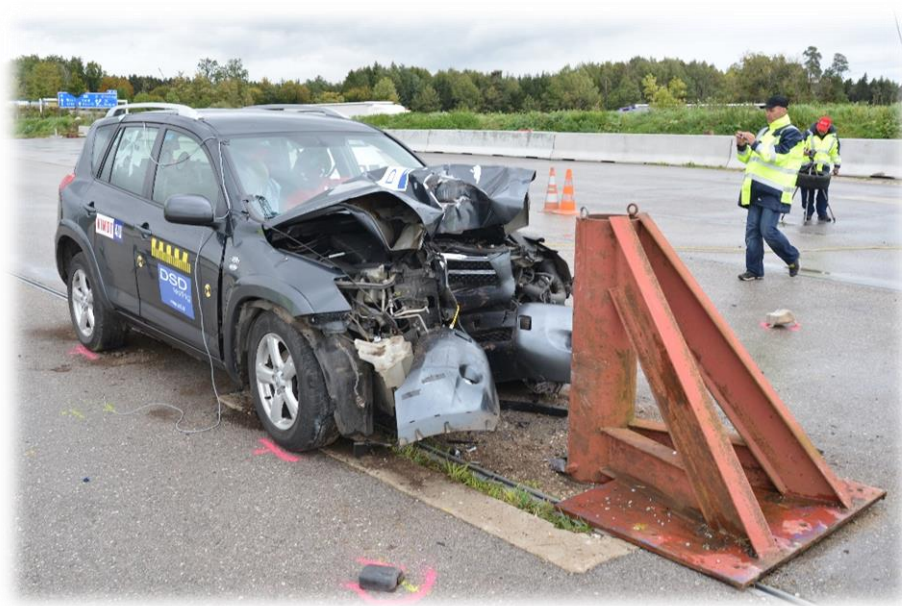
Obrázek 16: Toyota RAV4 po čelním nárazu do statické bariéry
