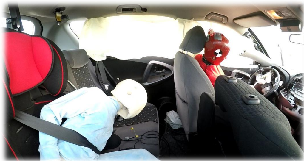
Obrázek 20: Interiér vozu po nárazu
