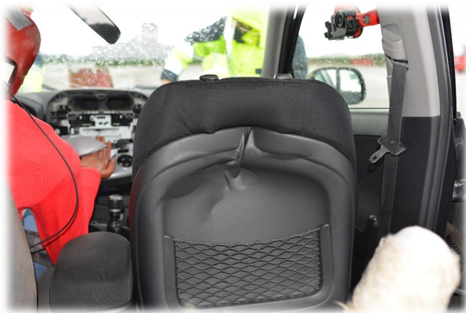
Obrázek 18: Sedadlo, poškozené nárazem figuríny psa
