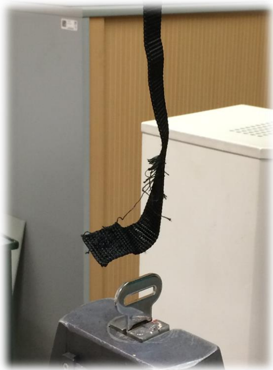
Obrázek 40: Vzorek číslo jedna po dokončení tahové zkoušky
