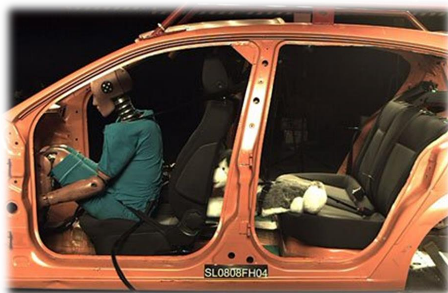
Obrázek 7: Záběr vysokorychlostní kamery crash testu při použití bezpečnostního popruhu [12]
