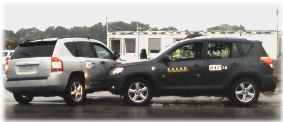
Obrázek 15: Čelní náraz do boku stojícího vozidla
