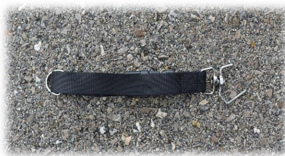
Obrázek 17: Poškozený bezpečnostní popruh pro přepravu psů
