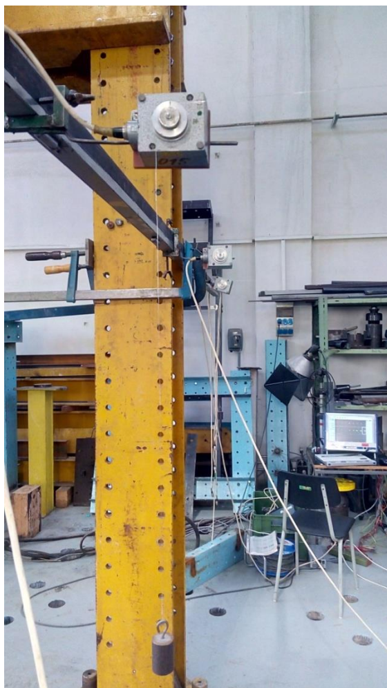
Obr. 20 Zapojené snímače dráhy
