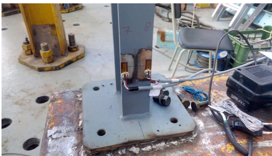
Obr. 19 Nalepené tenzometry na sloupku profilu IPE 80
