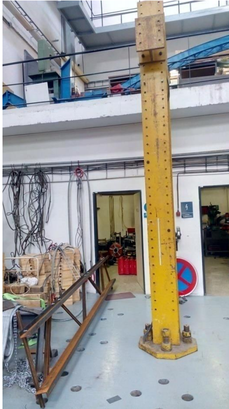
Obr. 7 Fotka ocelového pojezdového roštu a opěrného sloupu
