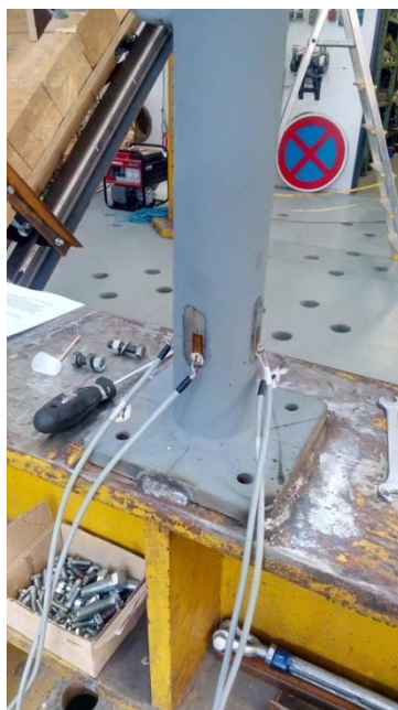
Obr. 18 Nalepené tenzometry na sloupku profilu TR 76x5
