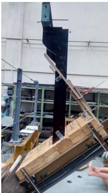
Obr. 12 Fotka pojezdového vozíku s opěrným rámem na jízdní dráze
