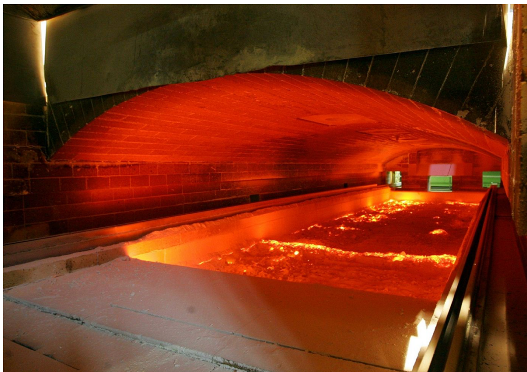
Obr. 3.6: Tavící agregát (tavící pec) [19]
