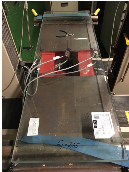
Obr. 5.17: Těleso ESG-PVB-03 v průběhu přípravy k měření
