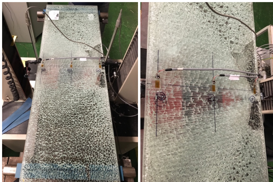
Obr. 5.19: Způsob porušení zkušebního tělesa
