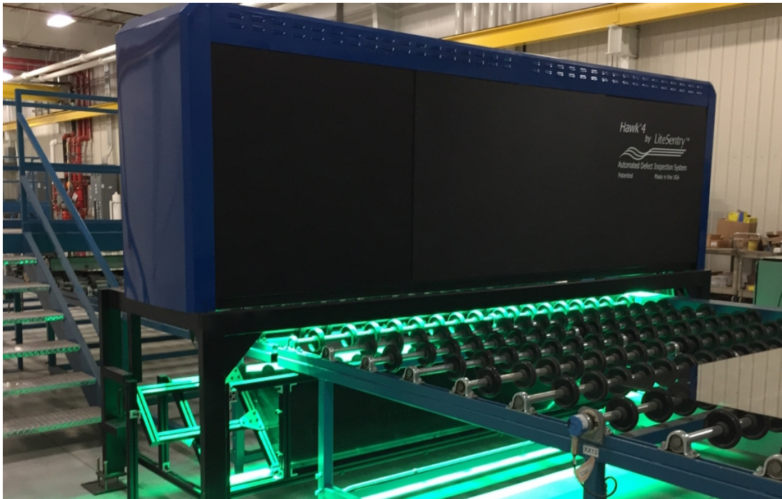
Obr. 3.14: Typ laserové detekce nazývající se ISRA
