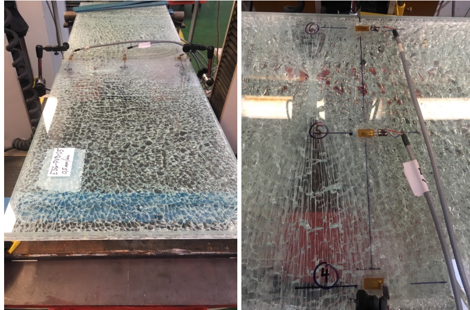
Obr. 5.26: Způsob porušení zkušebního tělesa
