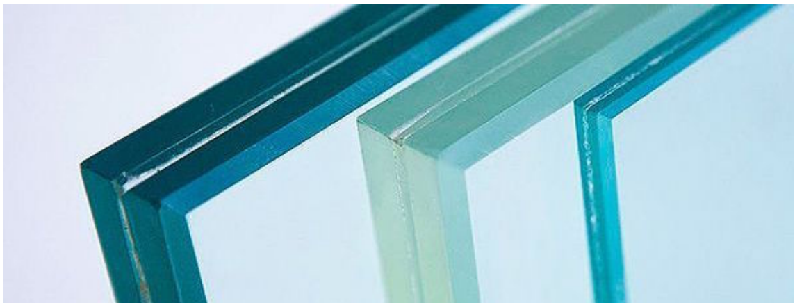
Obr. 4.1: Příklady vrstveného skla se spojující PVB fólií
