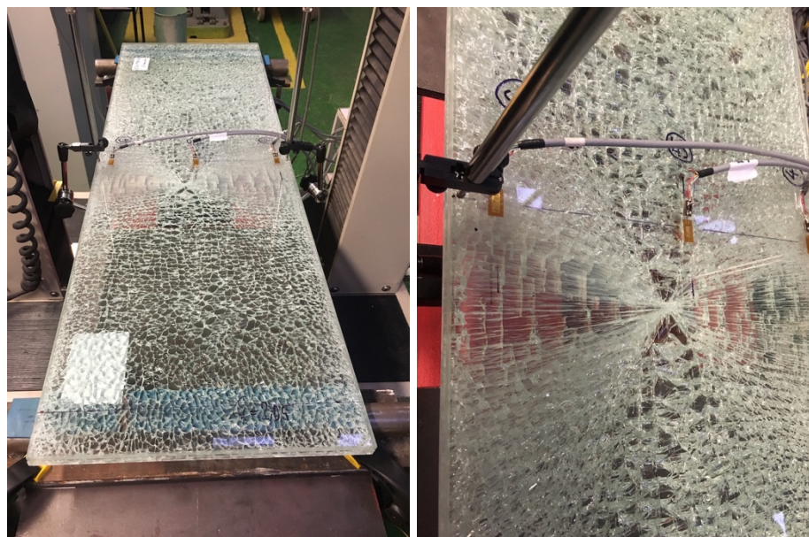
Obr. 5.29: Způsob porušení zkušebního tělesa
