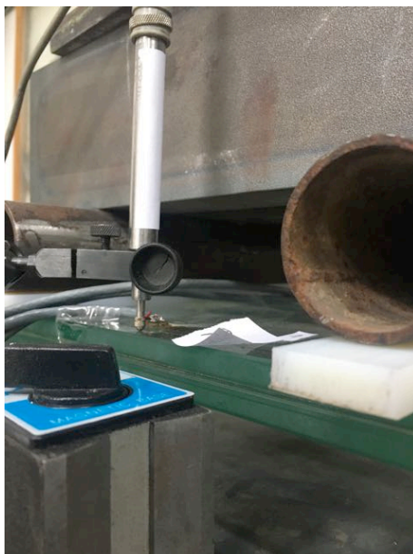
Obr. 5.46: Detail ochrany kontaktů mezi sklem a roznášecí soustavou
