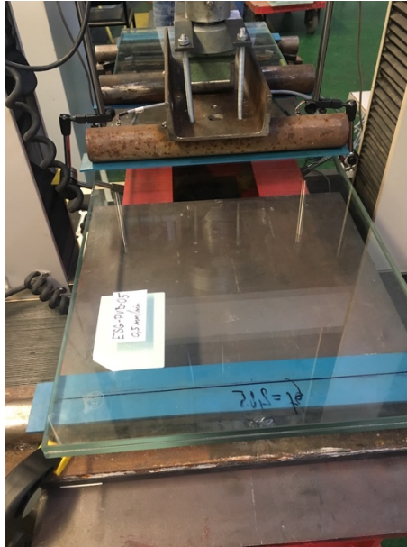
Obr. 5.24: Těleso ESG-PVB-05 ve zkušebním zařízení
