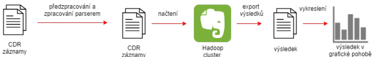
Obr. 3.7: Návrh řešení pro automatické zpracování CDR záznamů
