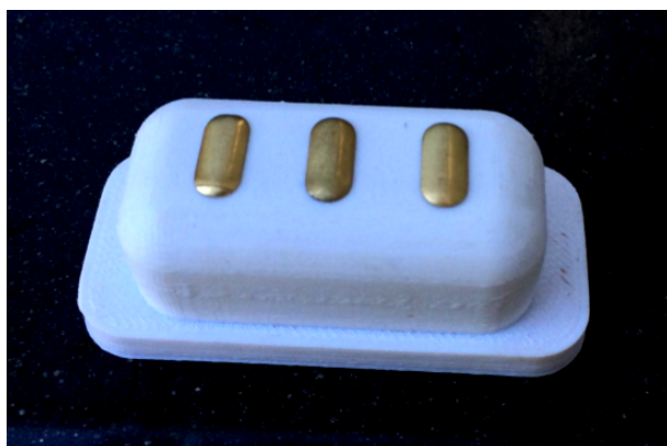
Obrázek 12.4: Elektrody vyrobené z jednoho kovu nepředstavují riziko vzniku elektrochemického článku
