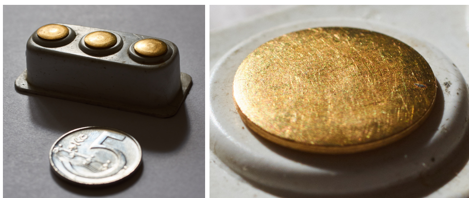
Obrázek 12.3: Elektrody vyrobené z pozlacené mědi, představující nebezpečí vzniku elektrochemického článku, vpravo je detail s patrnými povrchovými škrábanci, fotografie: Petr Kaštánek
