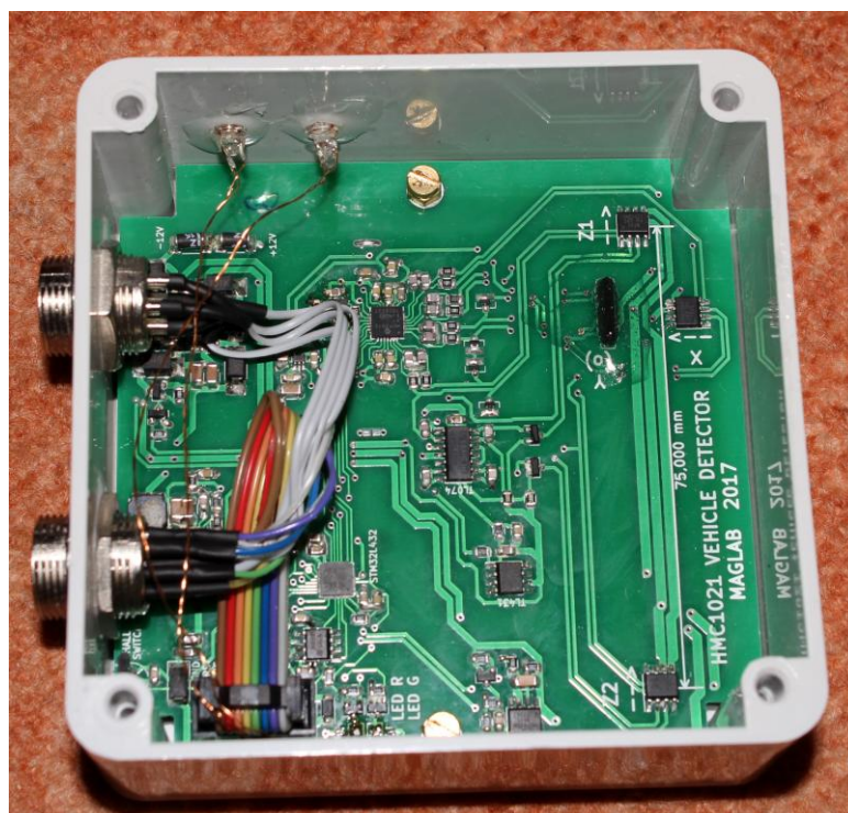
Obrázek 3.6 Současná verze auto-detektoru v krabičce s konektory
