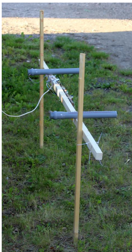
Obrázek 3.26 Vlevo pohled na optozávory s korelačním senzorem, vpravo stojan s lasery
