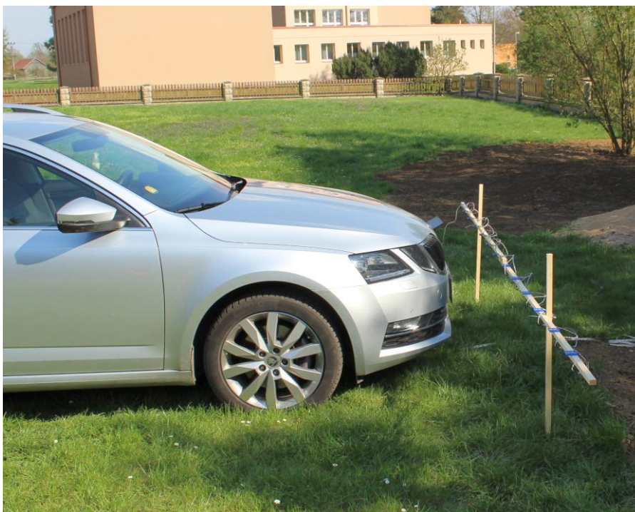
Obrázek 2.3 Fotografie z měření magnetického pole před automobilem
