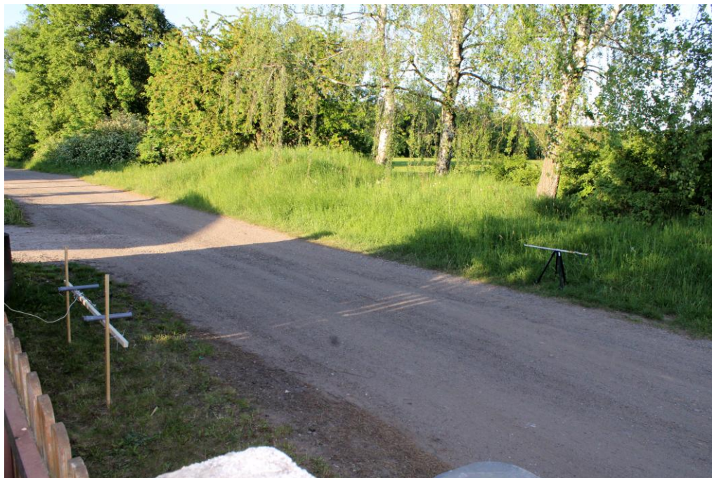
Obrázek 3.25 Fotografie testovacího uspořádání korelačního měření na silnici
