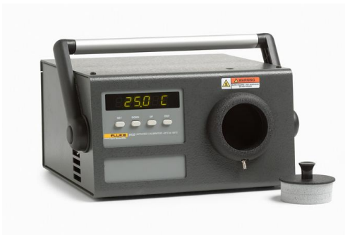
Obrázek 18: Kalibrační černé těleso FLUKE 9133 [4]
