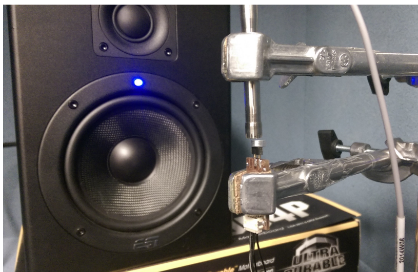
Obr. 3.10: Detail na instalaci mikrofonů a reproduktoru v akusticky upraveném prostoru
